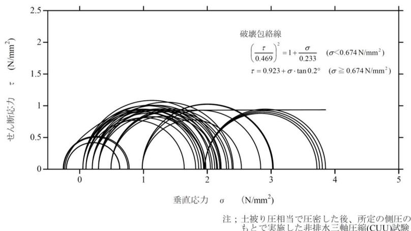
図 5.1-1 久米層の CUU 試験によるモール円
