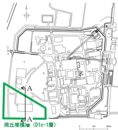
左図に示す範囲に分布するが、同範囲で分布する砂礫層 (D1g-1 層) の中の極めて狭い範囲に局所的に分布する地層であり、耐震評価用の地質断面図には出てこない。
