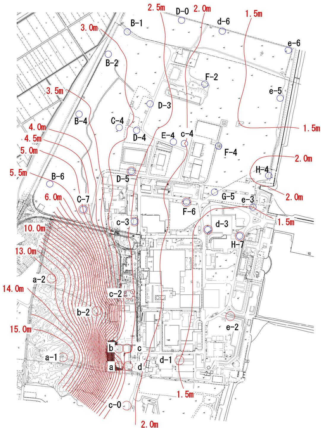
図 3.3-1 観測最高地下水位コンター図
