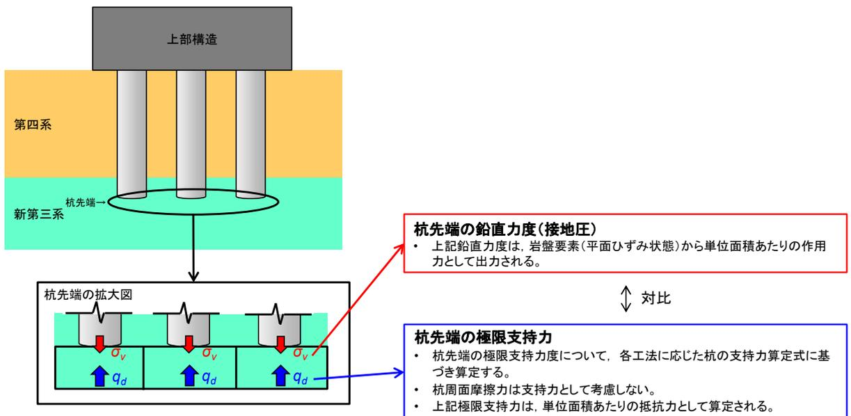
図1 押し込み力に対する杭基礎の支持力評価
