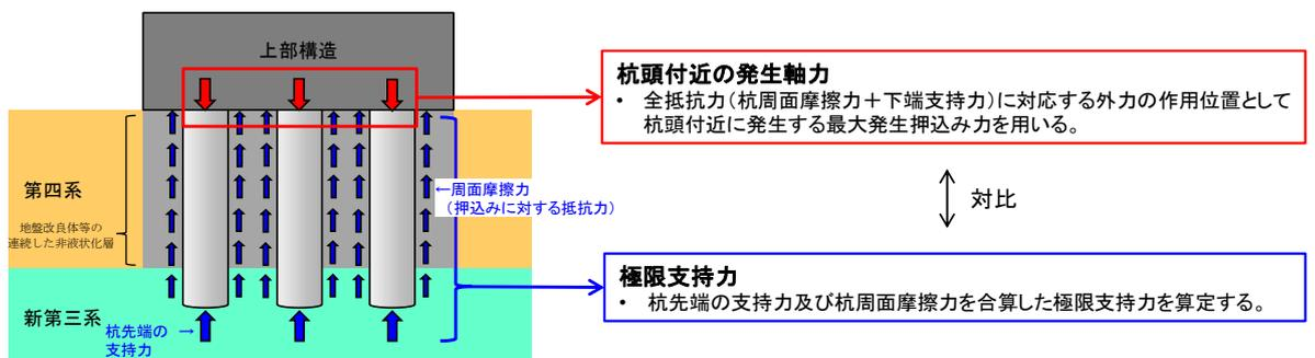
図2 押し込み力に対する杭基礎の支持力評価
