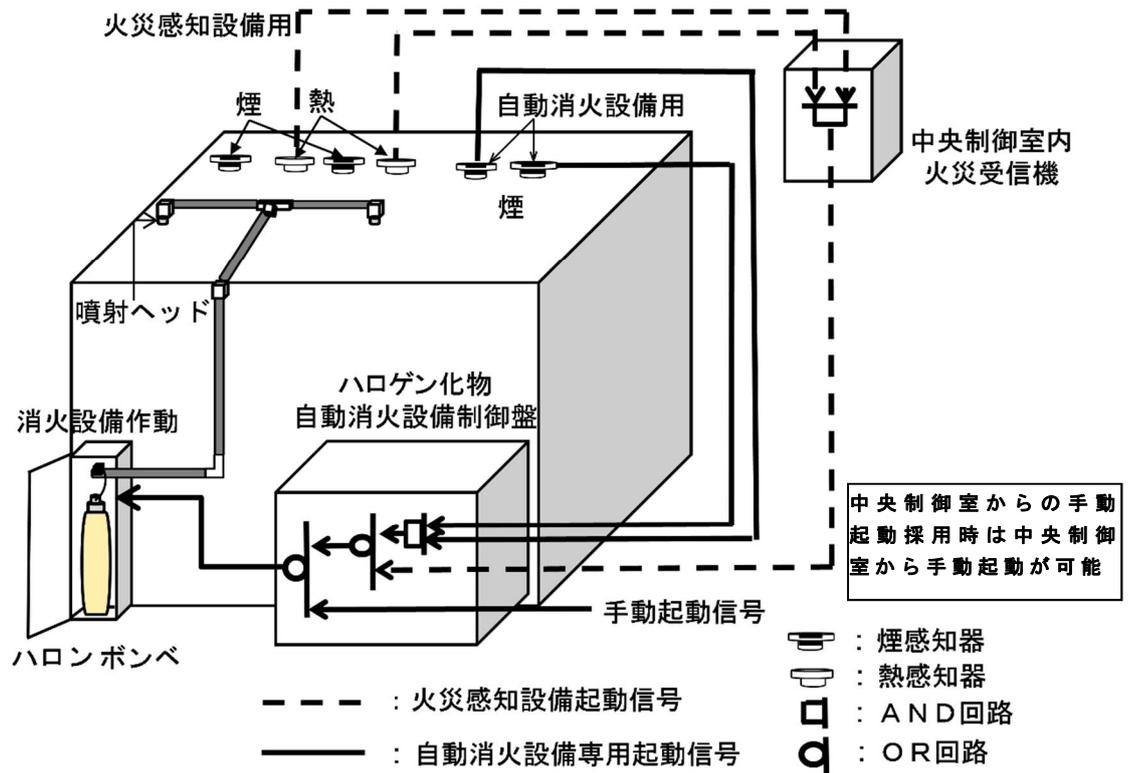
第1図 ハロゲン化物自動消火設備（全域）（ハロン 1301）動作概要
