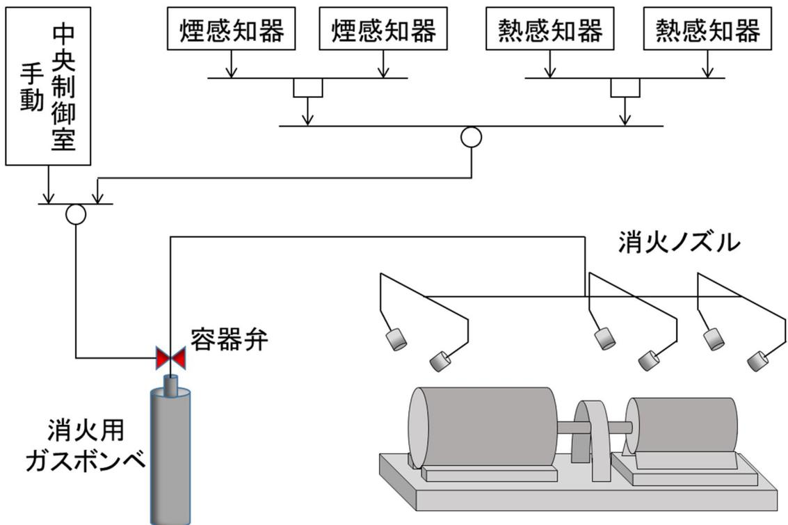
第2図 ハロゲン化物自動消火設備（局所）（ハロン 1301）概要図
