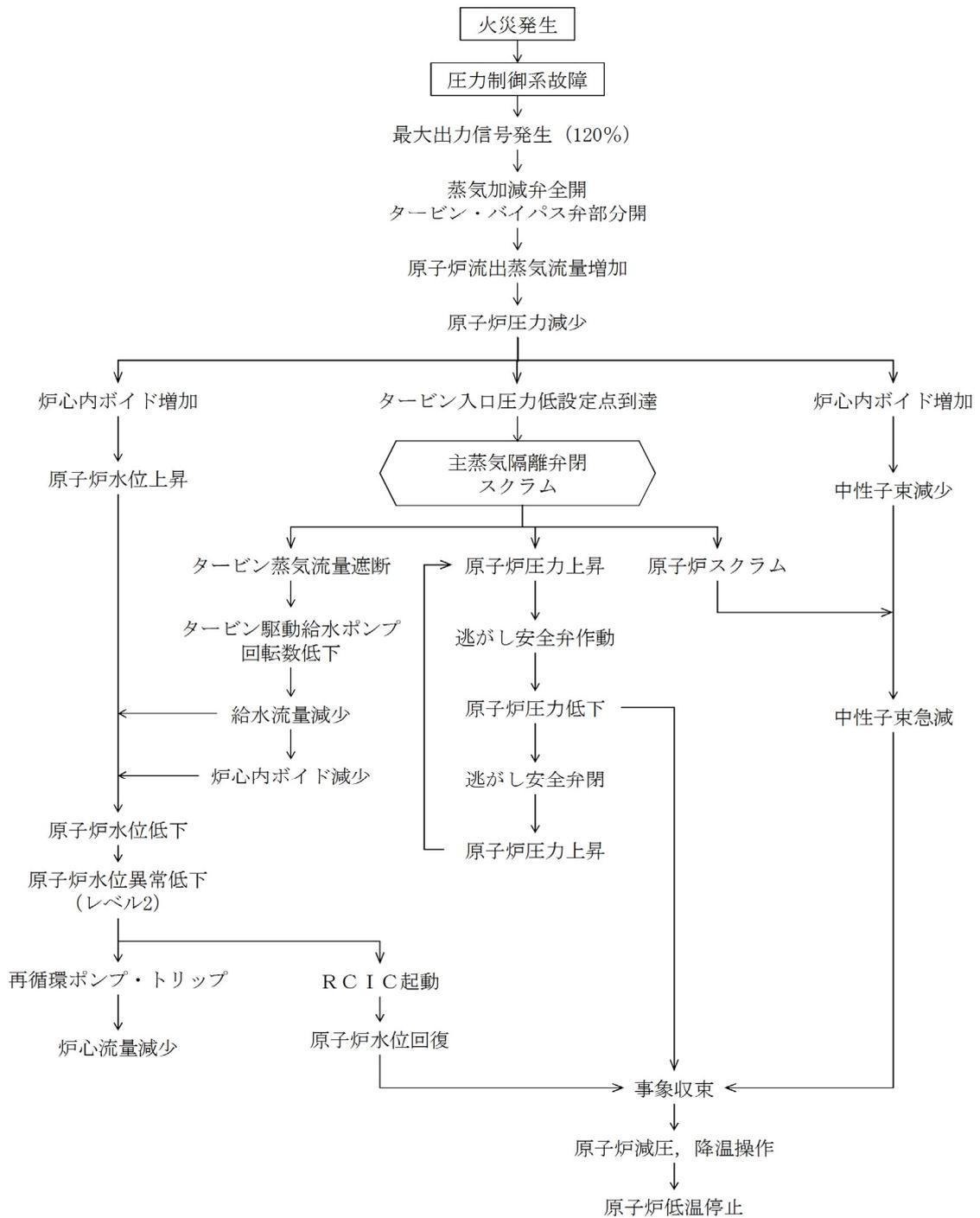
第 12 図 「圧力制御系の故障」の事象過程
