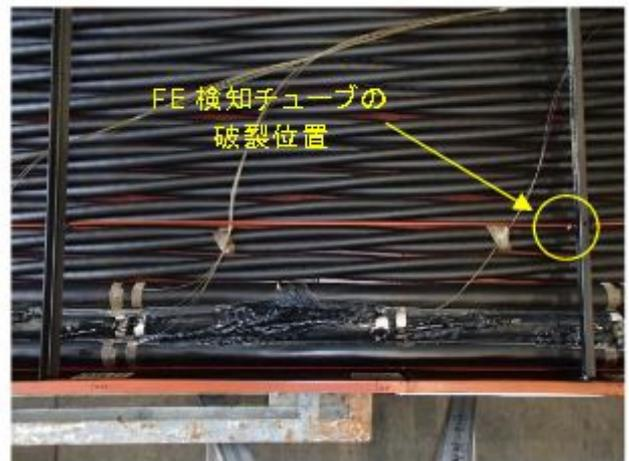
第 7 図 試験 H2 発火・消火・試験後の状態
