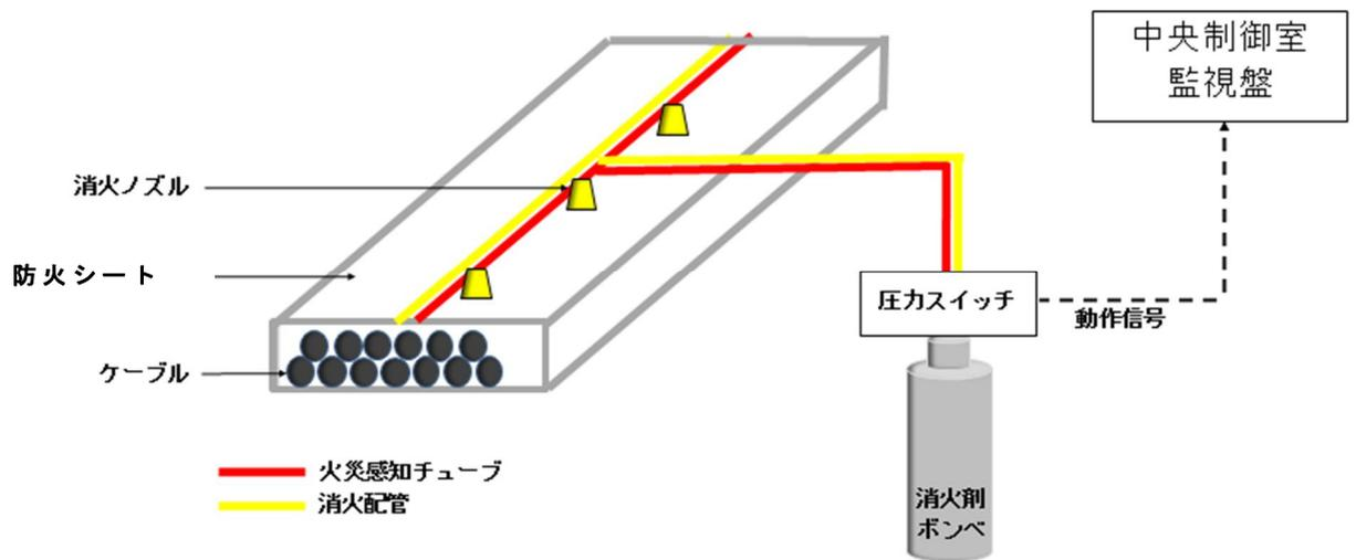
第 3 図 ケーブルトレイ消火設備 (FK-5-1-12) 概要図
