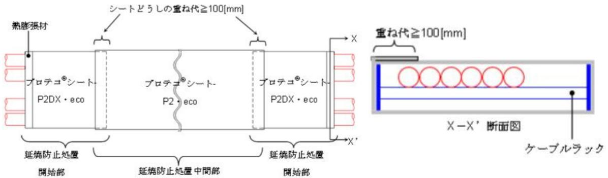
第1図 防火シートの標準的な巻き付け方法(※1 資料抜粋)
