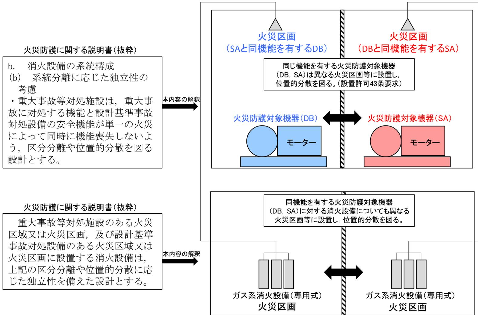
第1図 重大事故等対処施設及び設計基準事故対処設備の消火設備の
