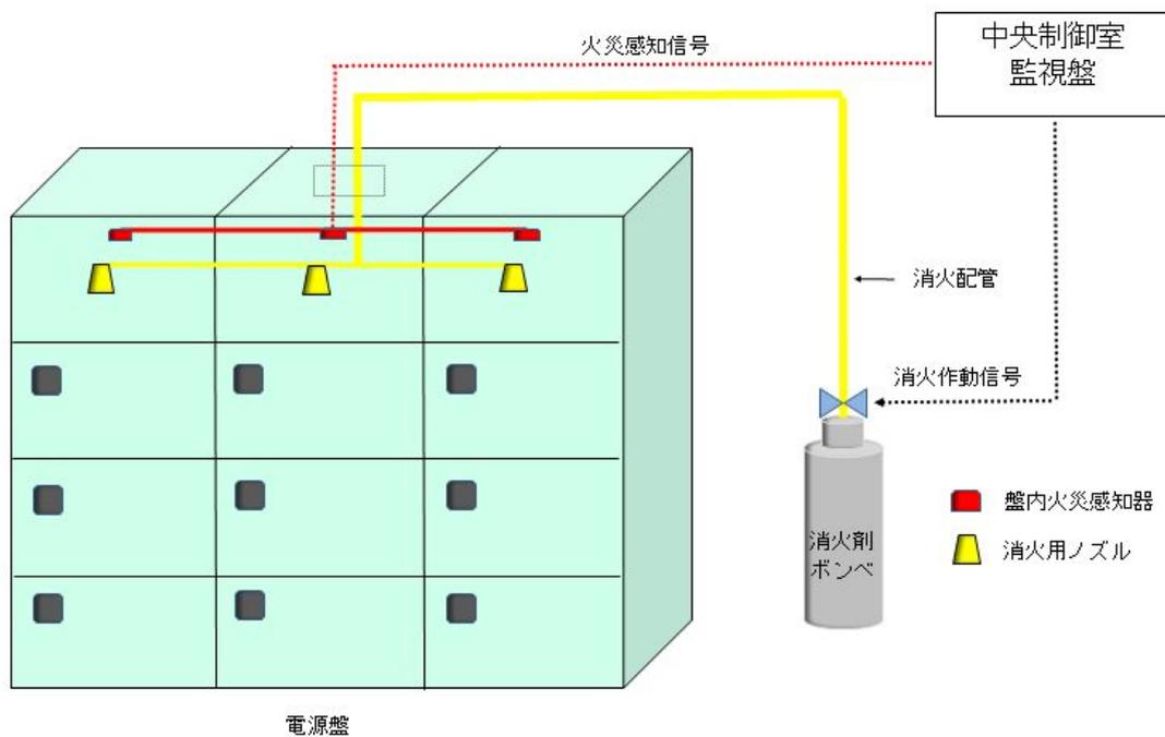
第 4 図 ハロゲン化物自動消火設備 (局所) (ハロン 1301) 概要図
