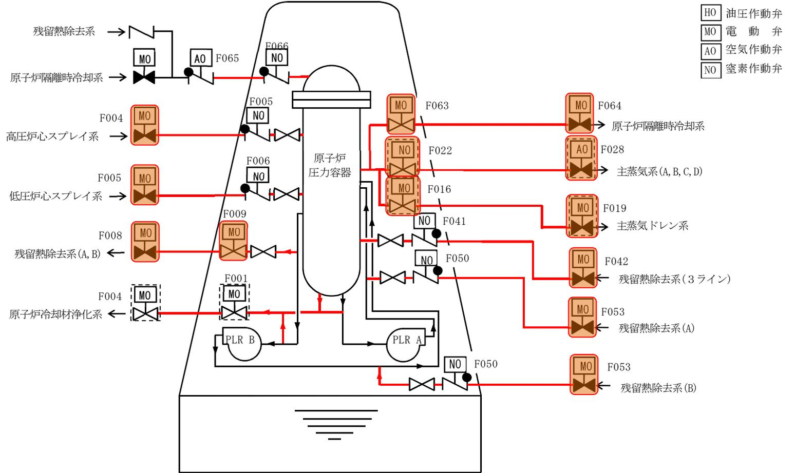
— 原子炉の安全停止に必要な系統機能を発揮するために必要なライン
