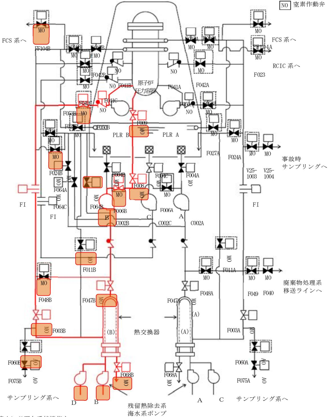
— 原子炉の安全停止に必要な系統機能を発揮するための必要なライン
