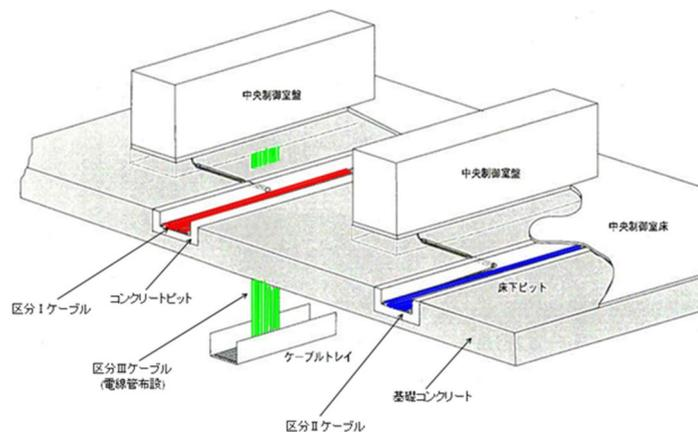
第2図 中央制御盤へのケーブル配線
