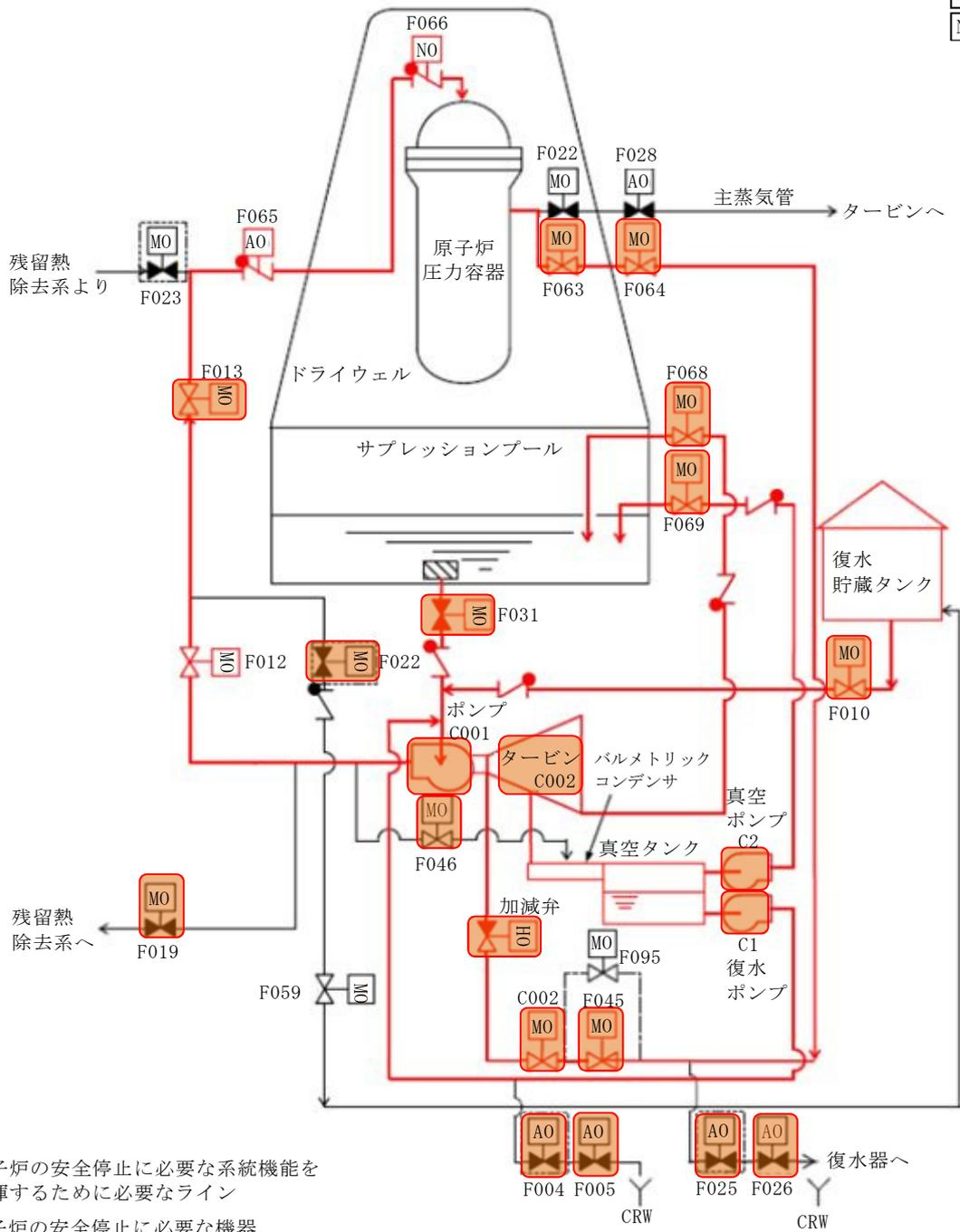
第4図 原子炉隔離時冷却系
