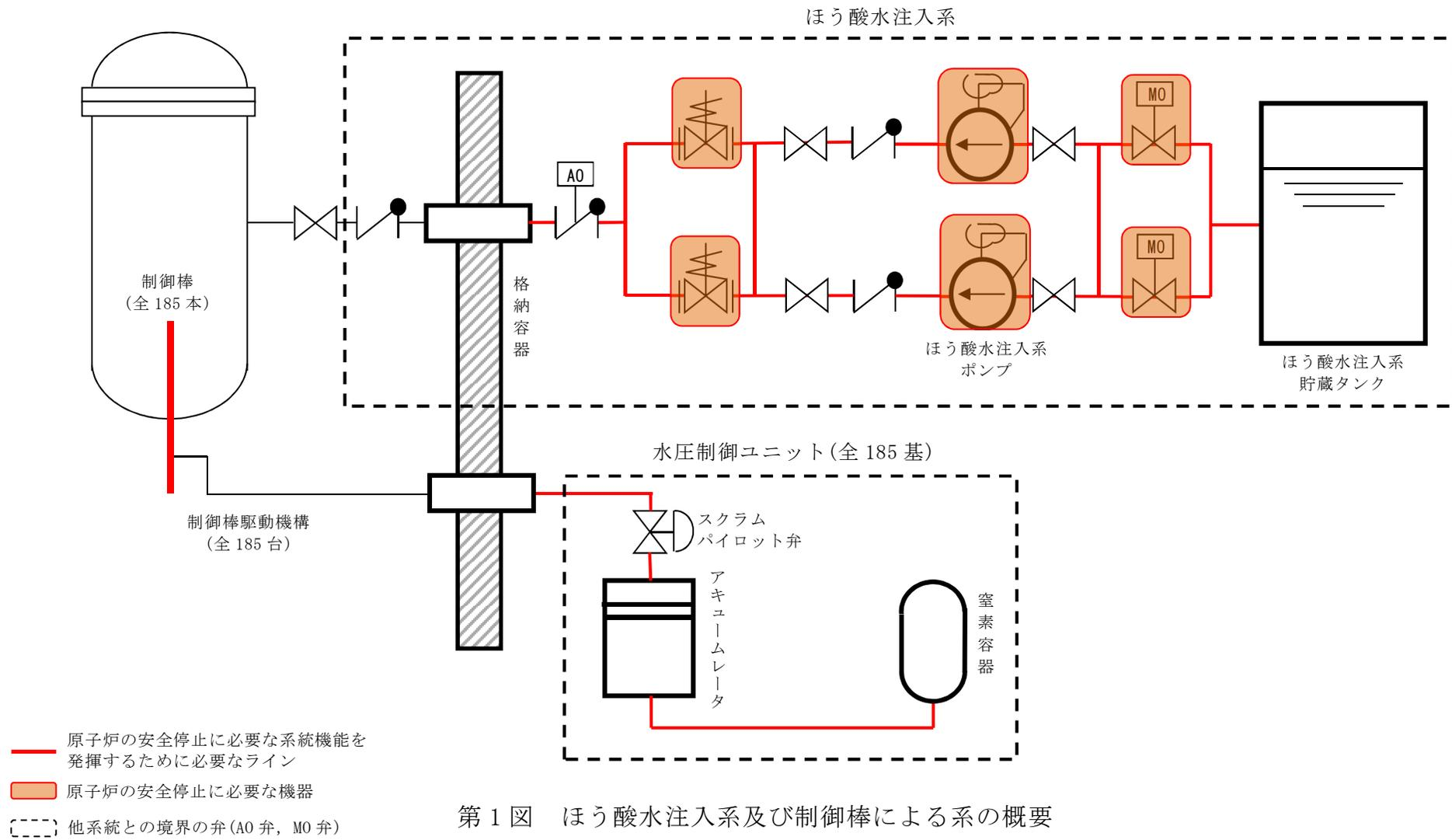
第 1 図 ほう酸水注入系及び制御棒による系の概要
