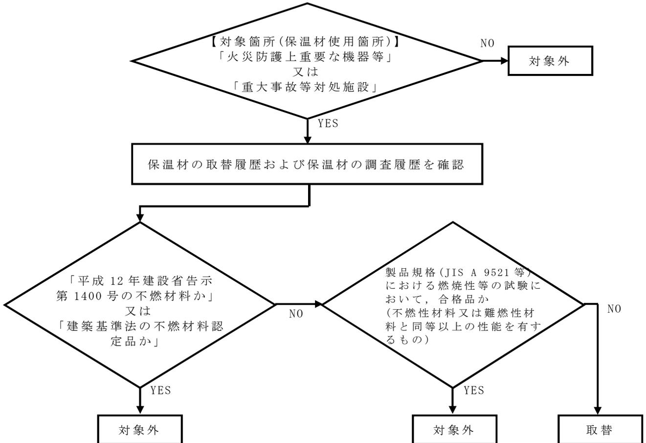
第1図 保温材の不燃性確認フロー
