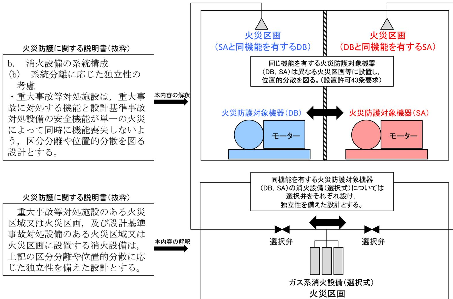
第2図 重大事故等対処施設及び設計基準対処設備の消火設備の
