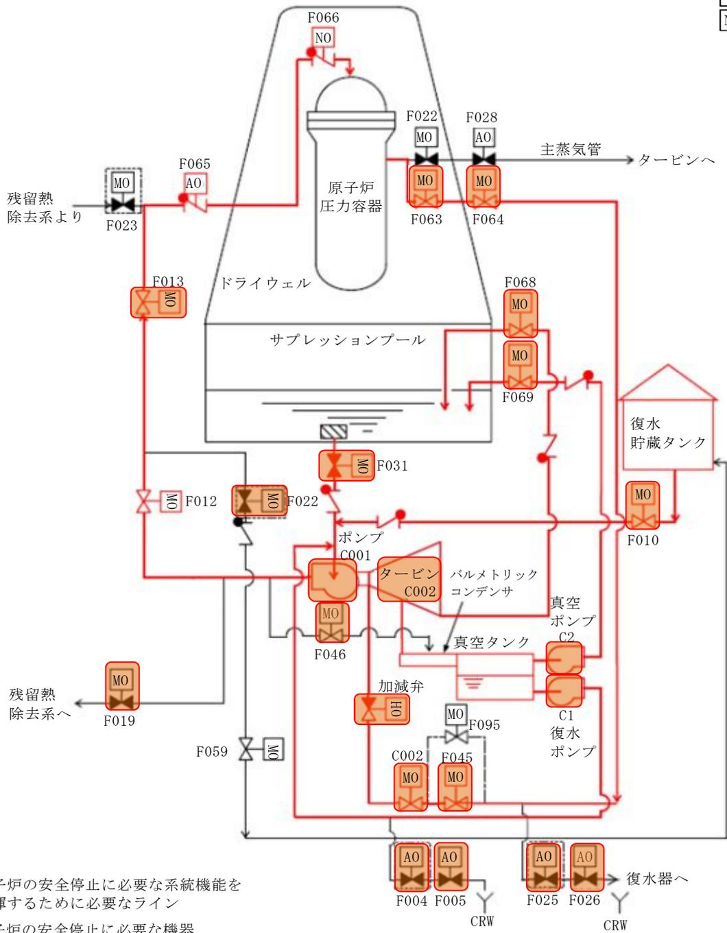
第4図 原子炉隔離時冷却系
