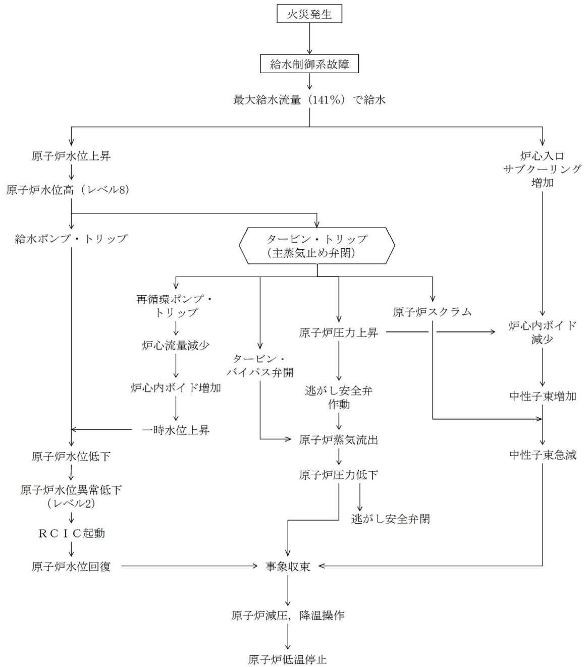
第 10 図 「給水制御系の故障」の事象過程
