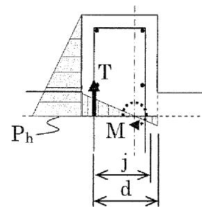
第5-12図 壁に生じる引張力の概念図
