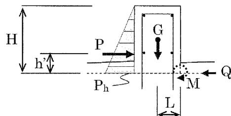
第5-15図 堤の応力算定モデル
