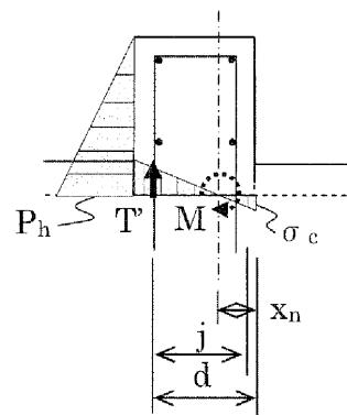
第5-13図 壁に生じる圧縮力の概念図
