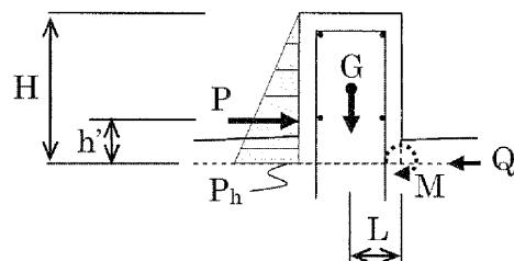
第5-9図 堤の応力算定モデル
