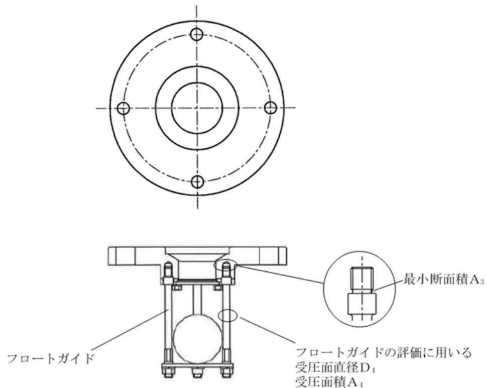
第5-21図 フロートガイドの強度評価に用いる受圧面直径及び断面積
