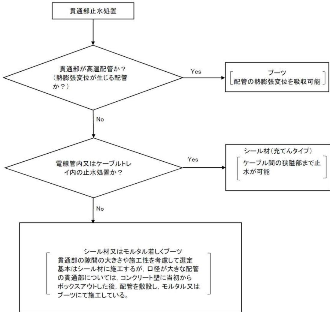
第3-2図 貫通部止水処置の選定フロー
