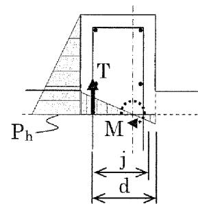
第5-18図 堤に生じる引張力の概念図
