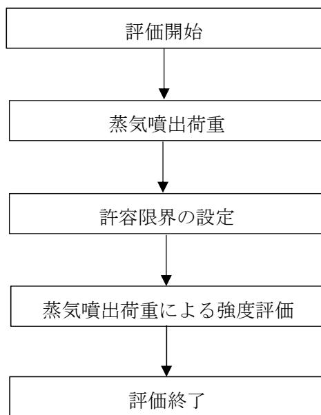
第2-2図 防護カバーの強度評価フロー
