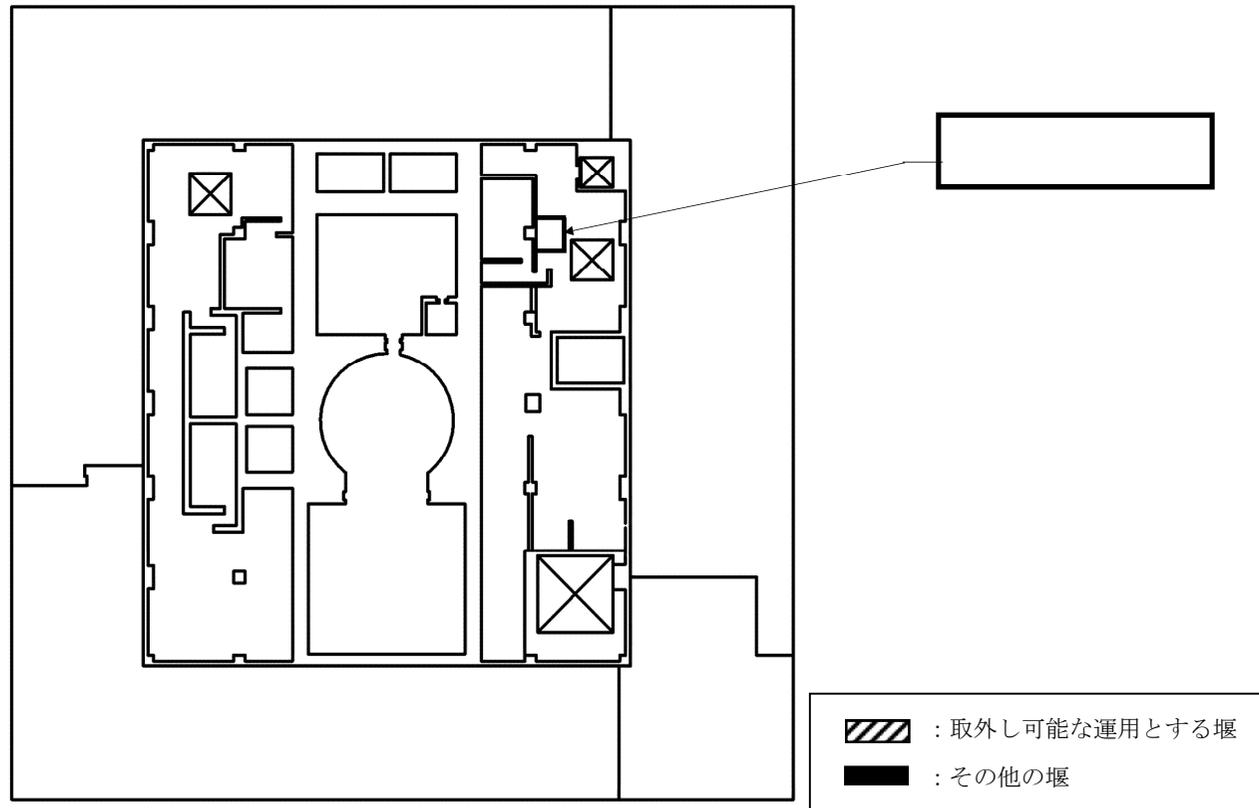
第2-13図 止水板の設置位置図 (EL. 38.80 m)
