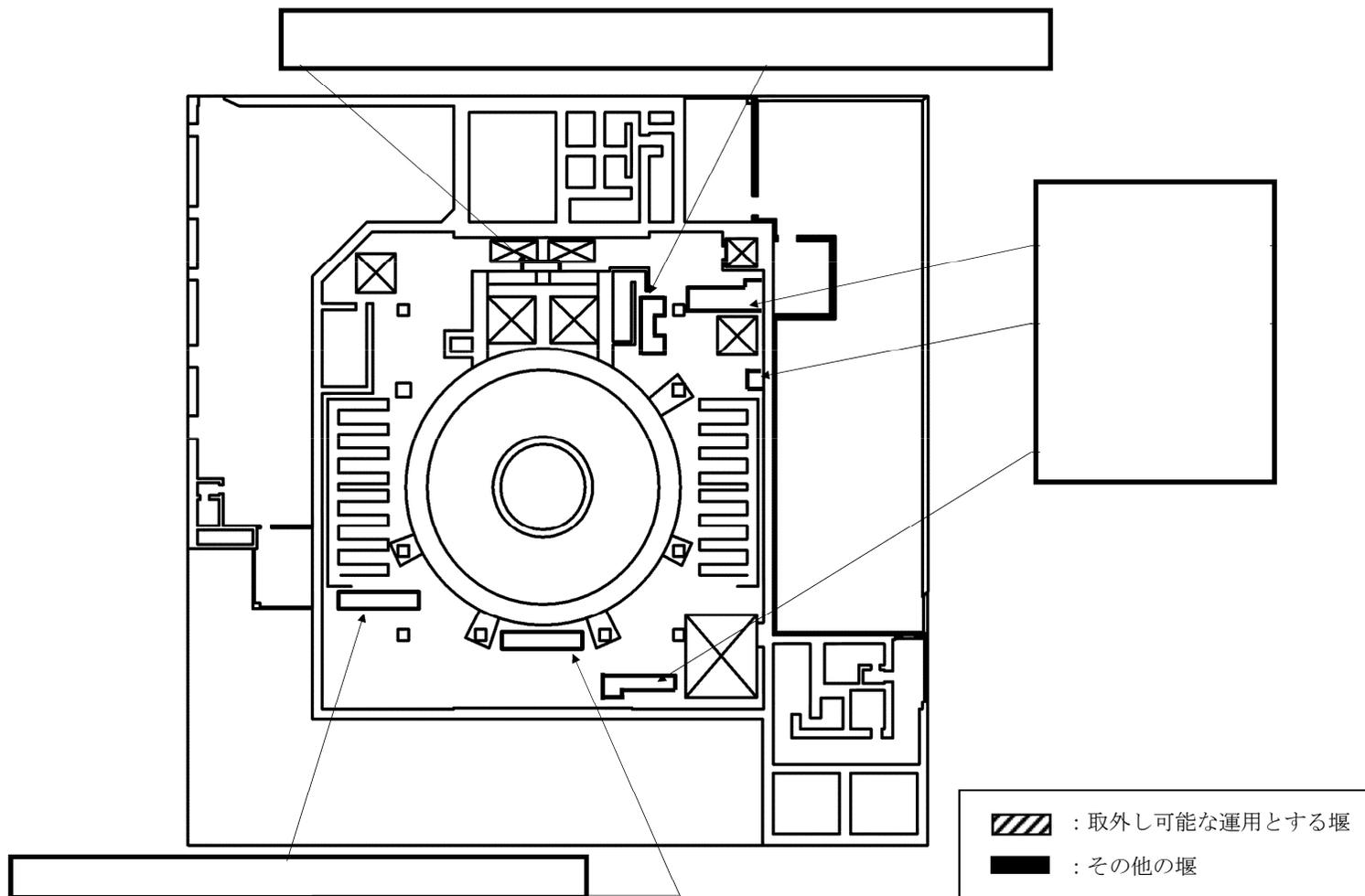
第2-11図 止水板の設置位置図 (EL. 20.30 m)
