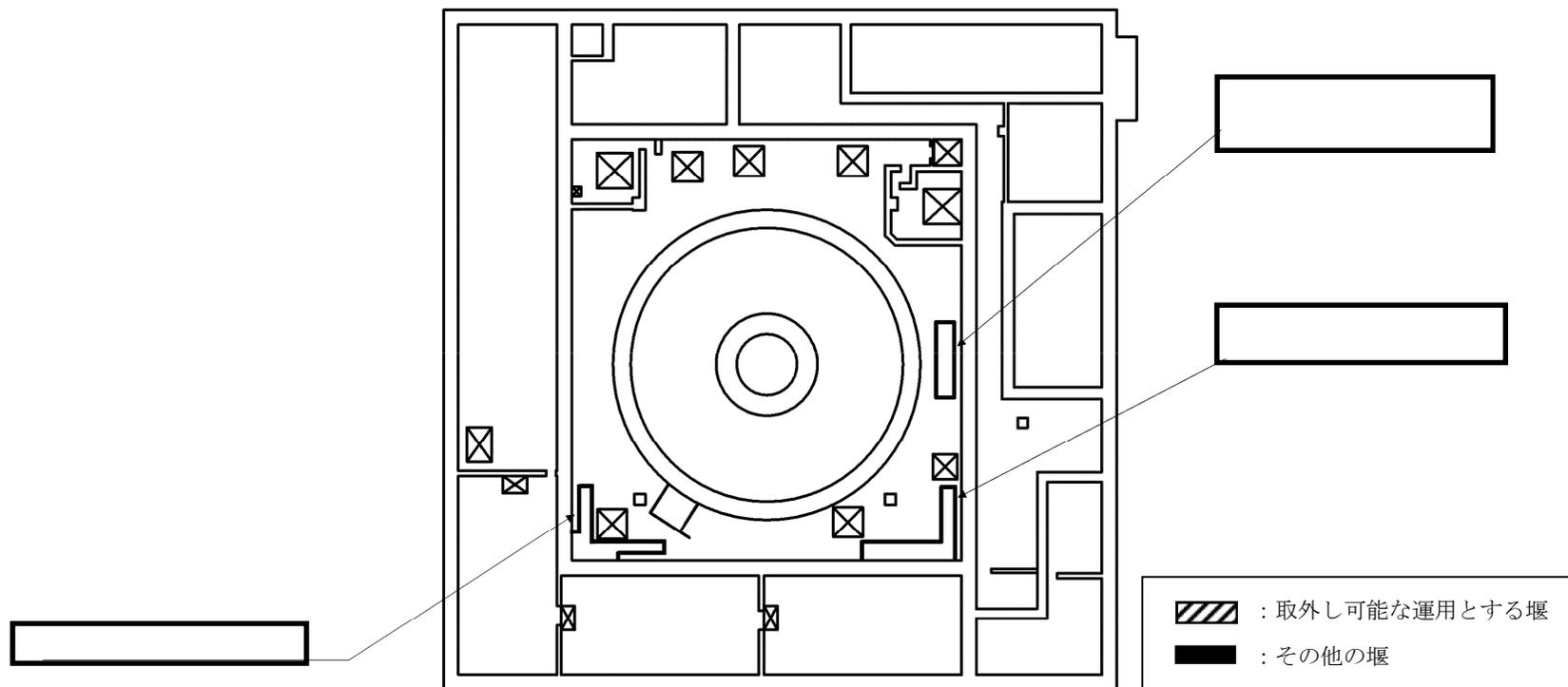
第2-9図 止水板の設置位置図 (EL. 2.00 m)
