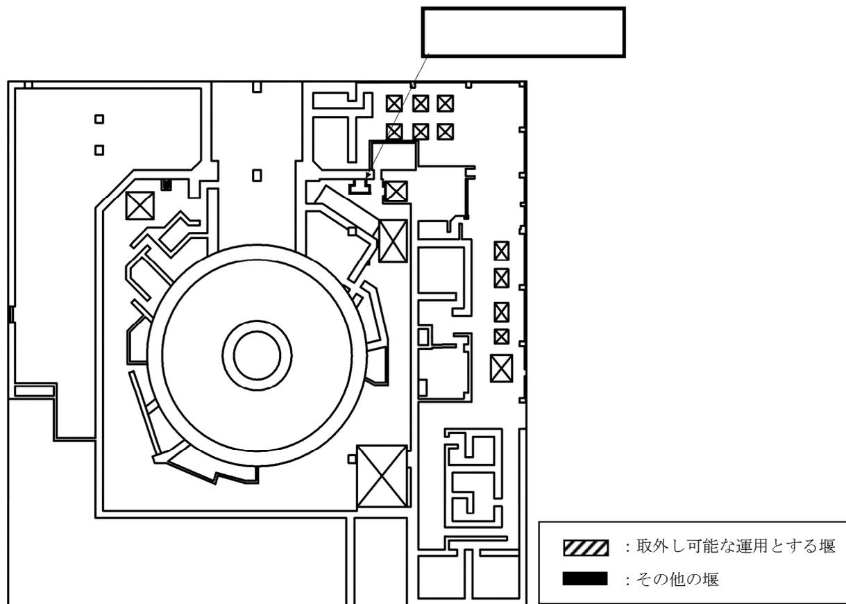
第2-10図 止水板の設置位置図 (EL. 14.00 m)
