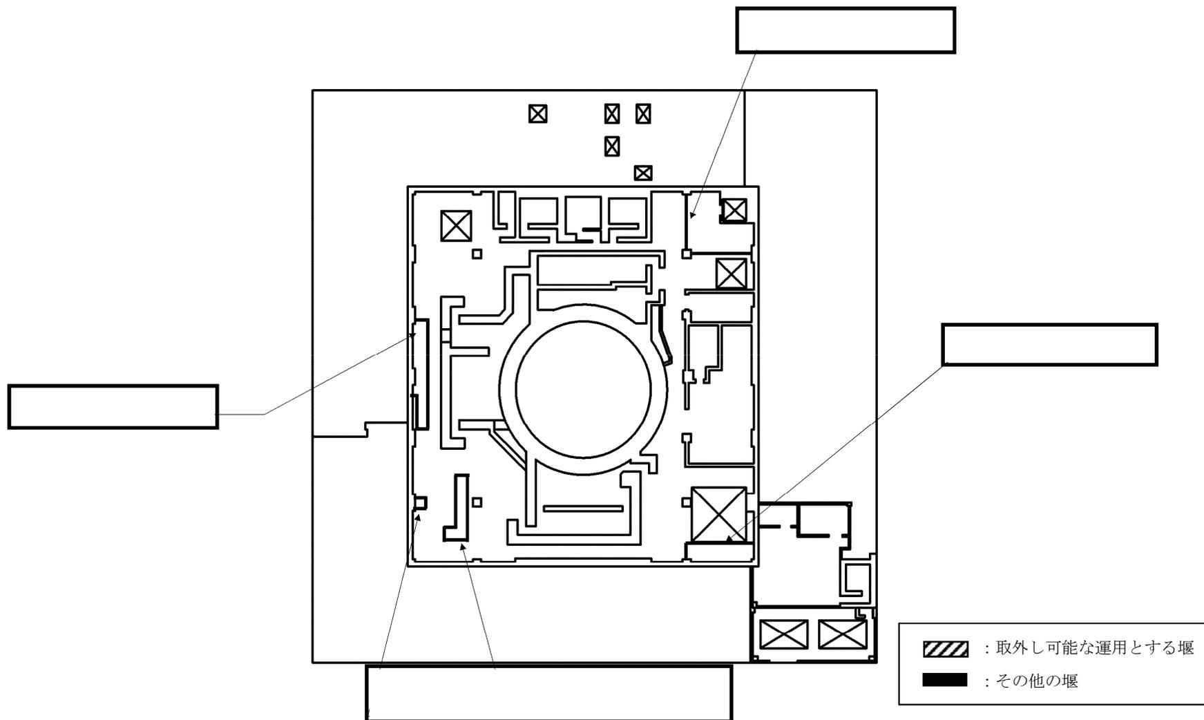
第2-12図 止水板の設置位置図 (EL. 29.00 m)
