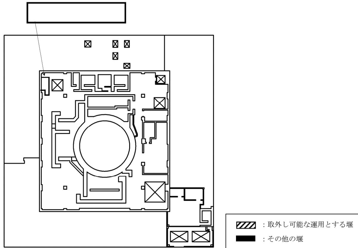
第 2-5 図 溢水拡大防止堰の設置位置図 (EL. 29.00 m)
