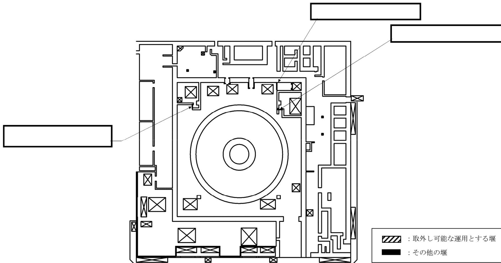
第 2-2 図 溢水拡大防止堰の設置位置図 (EL. 8.20 m)
