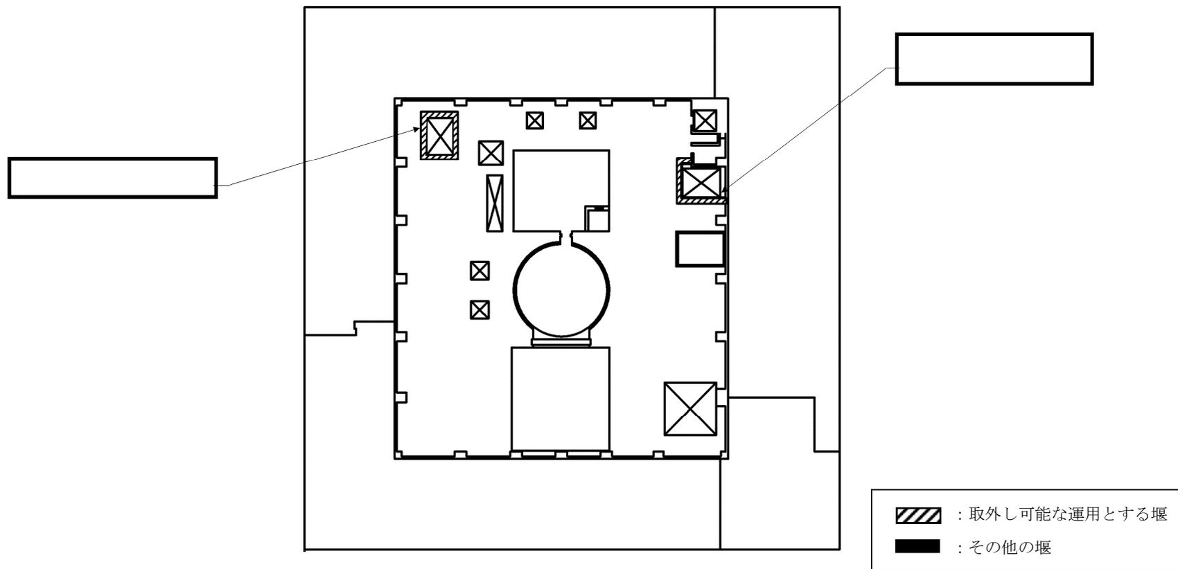
第 2-14 図 止水板の設置位置図 (EL. 46.50 m)
