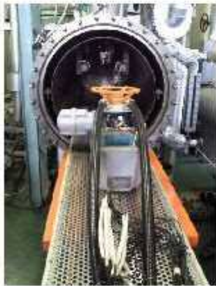
第 2 図 蒸気曝露試験装置 (例)
