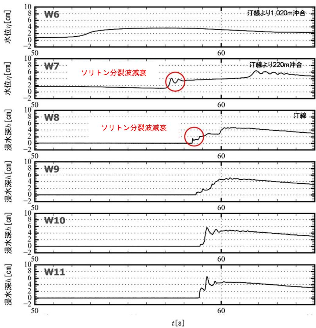
図 4.3.1.2-5 水理模型実験における時刻歴図
