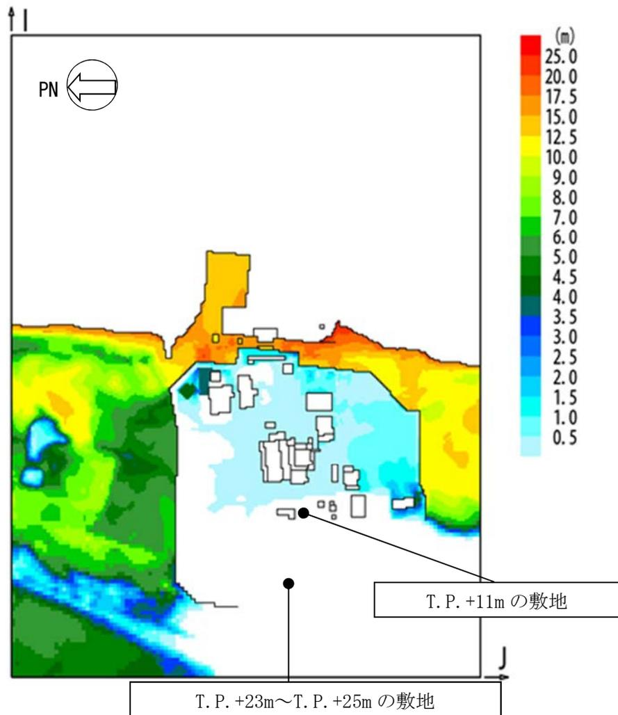
図 4.3.2.3-1 防潮堤内側における浸水深分布図 (1/2)
