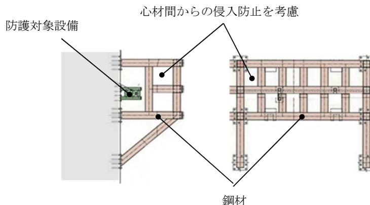
図 4.3.2.4-1 防護柵基本構造図
