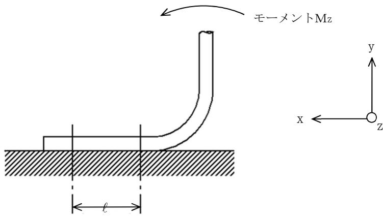
図 4-2 取付ボルトの取付図
