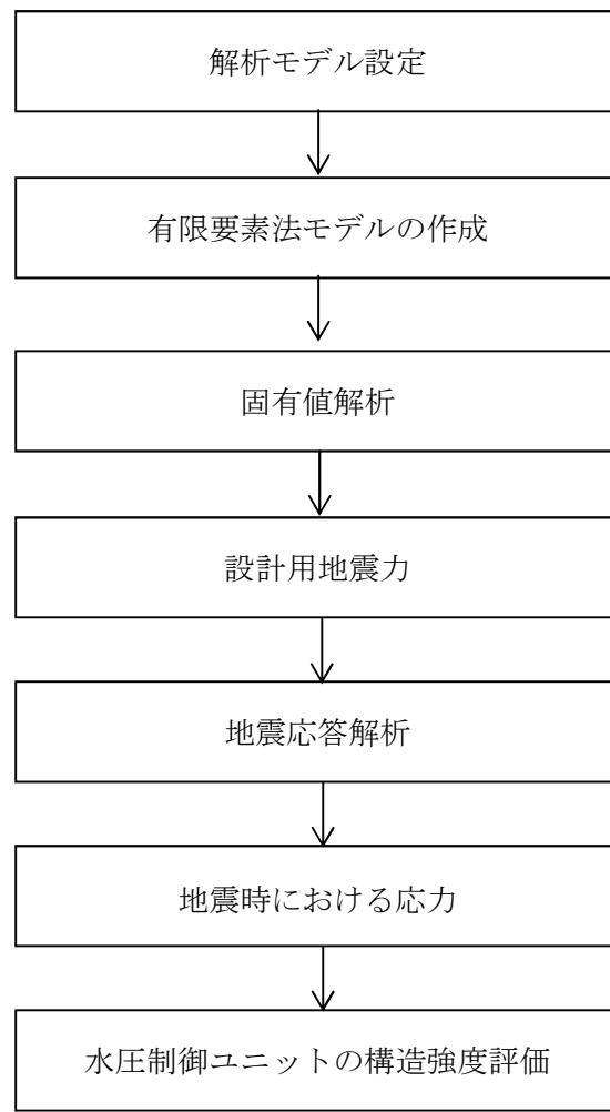
図 2-1 水圧制御ユニットの耐震評価フロー
