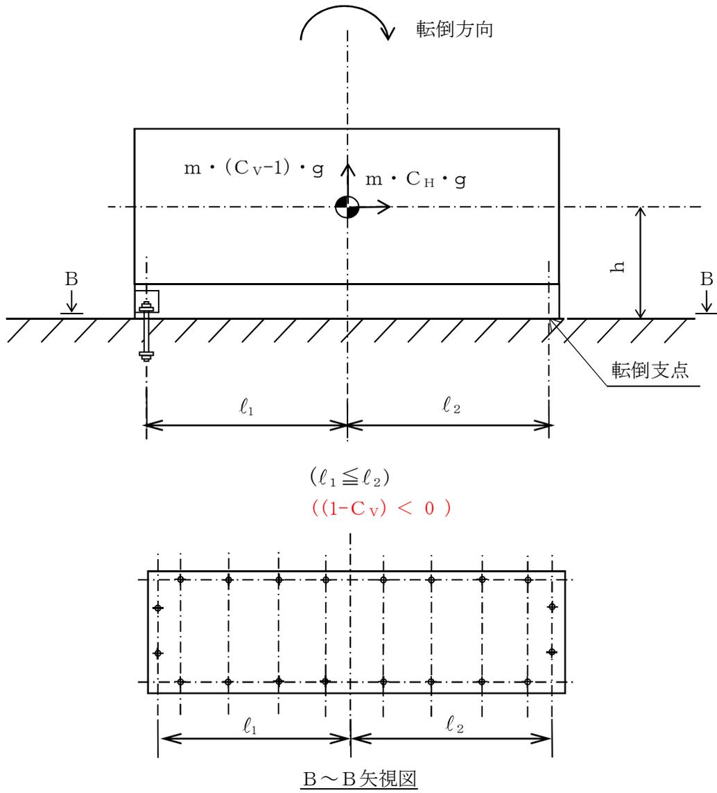
図 5-2 計算モデル (長辺方向転倒)
