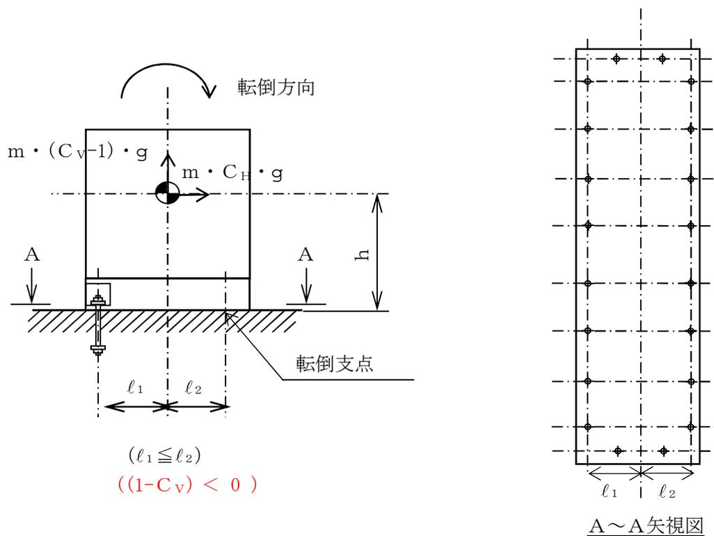
図 5-1 計算モデル（短辺方向転倒）
