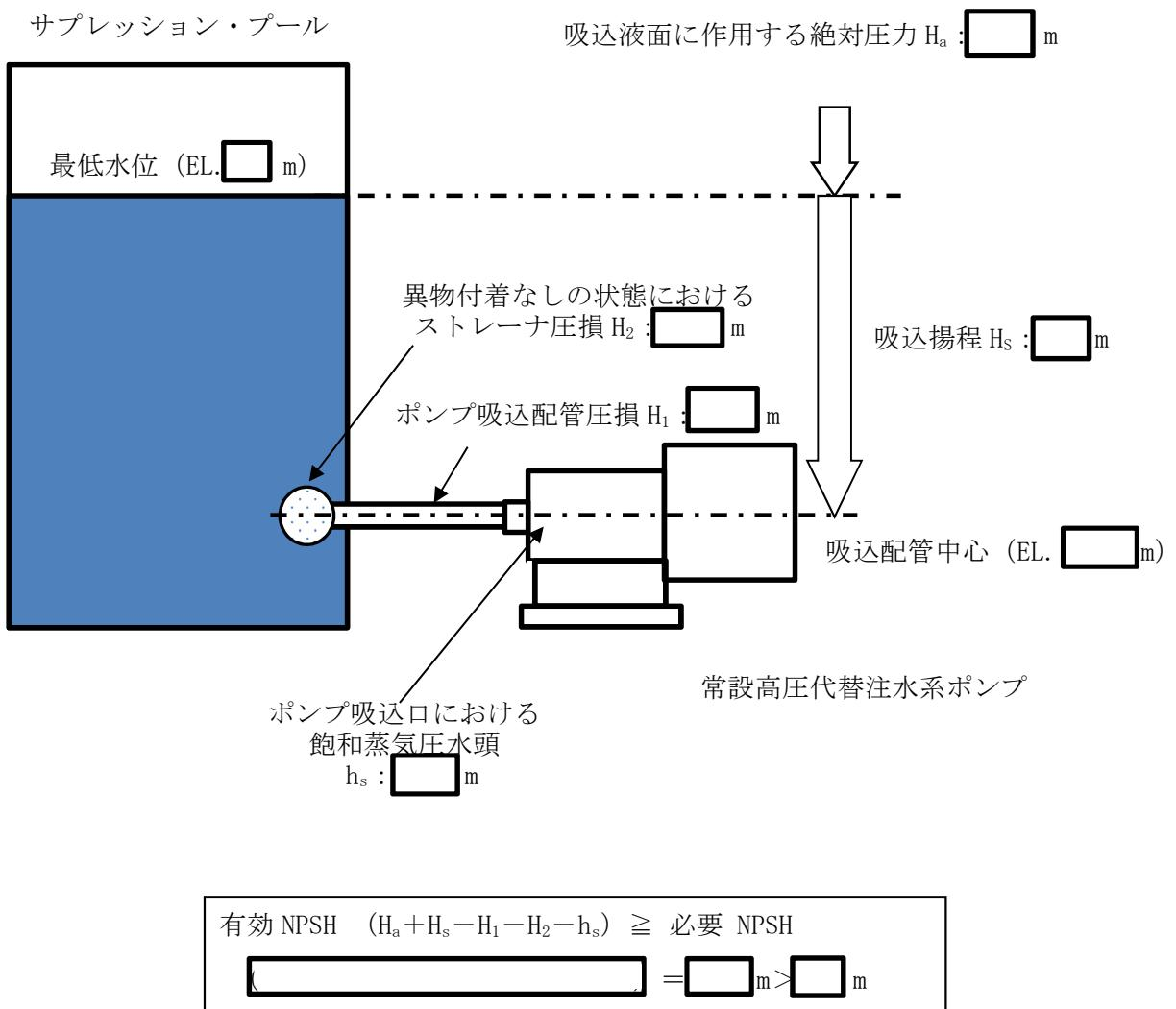
図 3.5.1.2-1 常設高压代替注水系ポンプの有効 NPSH 評価の概略図
