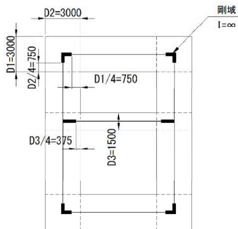
図 5-3 水平面断面フレーム解析における剛域の考え方
