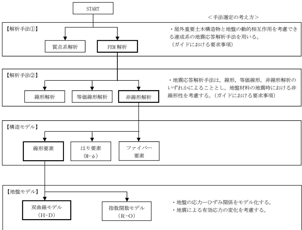
図 3-1 地震応答解析手法の選定フロー
