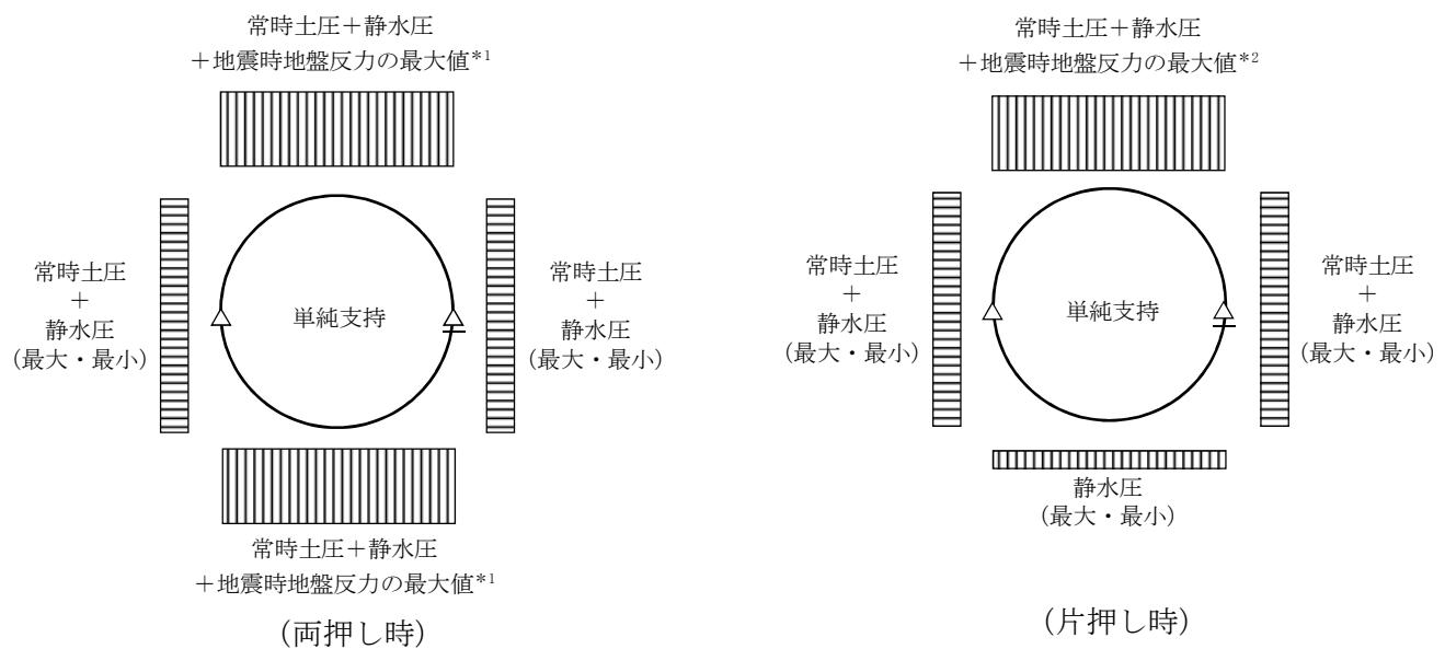
\*1 : 立坑左右地盤の「常時土圧+静水圧+地震時地盤反力の最大値」を両側に作用させる。
