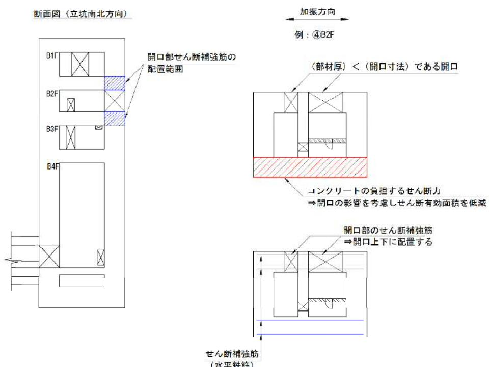
図 4-6 鉛直断面のせん断照査概念図
