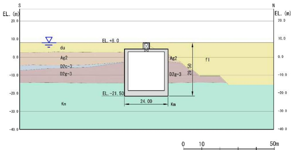
図 1-3 (3) 代替淡水貯槽地質断面図 (B-B断面)
