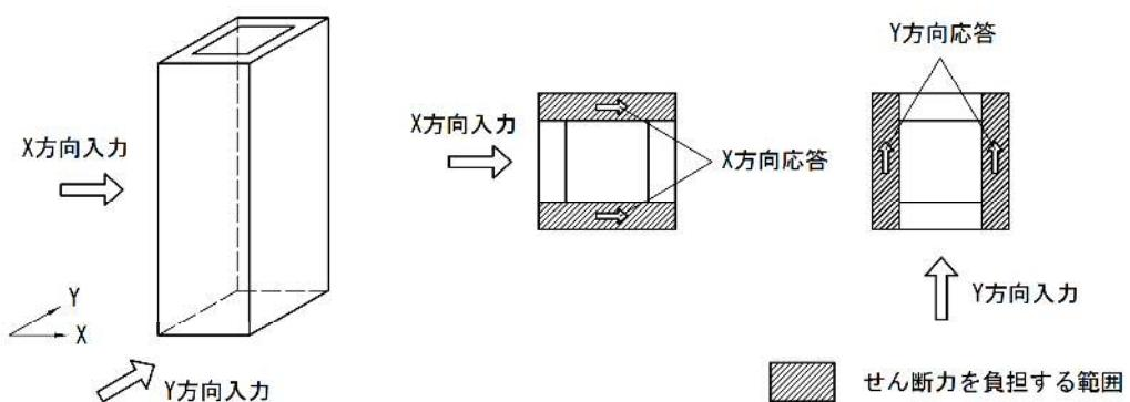
図 10-1 (2) 入力方向ごとの耐震要素（矩形立坑鉛直断面のせん断を対象）
