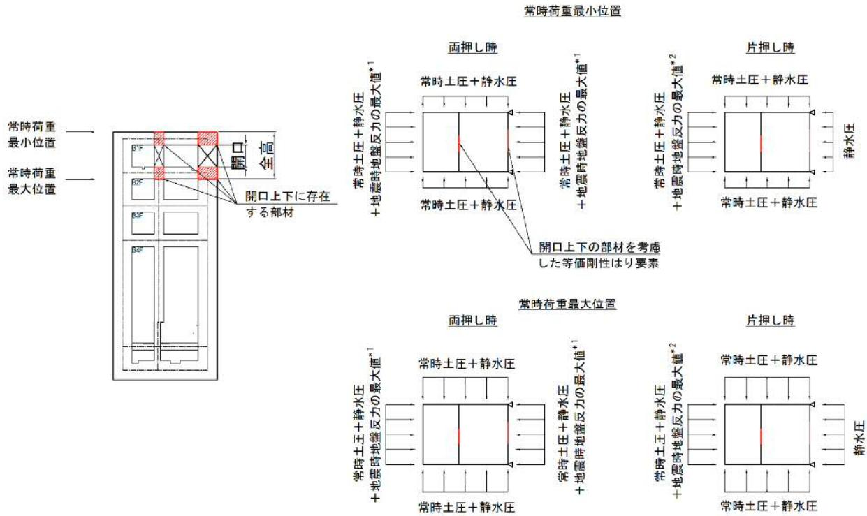
図 5-4 水平断面解析モデル概念図（開口部を含む構造部）
