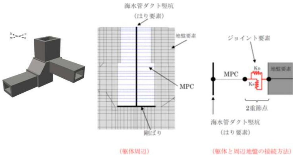
図 1-1 玄海 3 号機海水管ダクト堅坑モデル図
