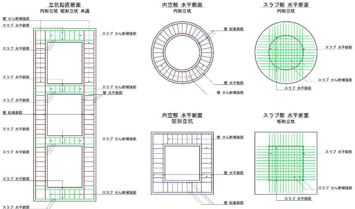
図 10-3 各部材評価で照査対象とする鉄筋
