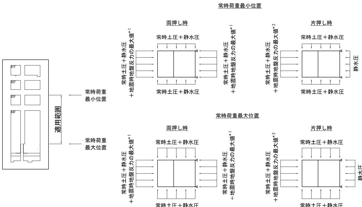
\*1 : 立坑左右地盤の「常時土圧+静水圧+地震時地盤反力の最大値」を両側に作用させる。
