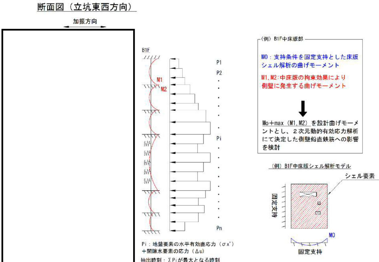
図 4-7 版部材から側壁に廻り込む曲げモーメント算定概念図
