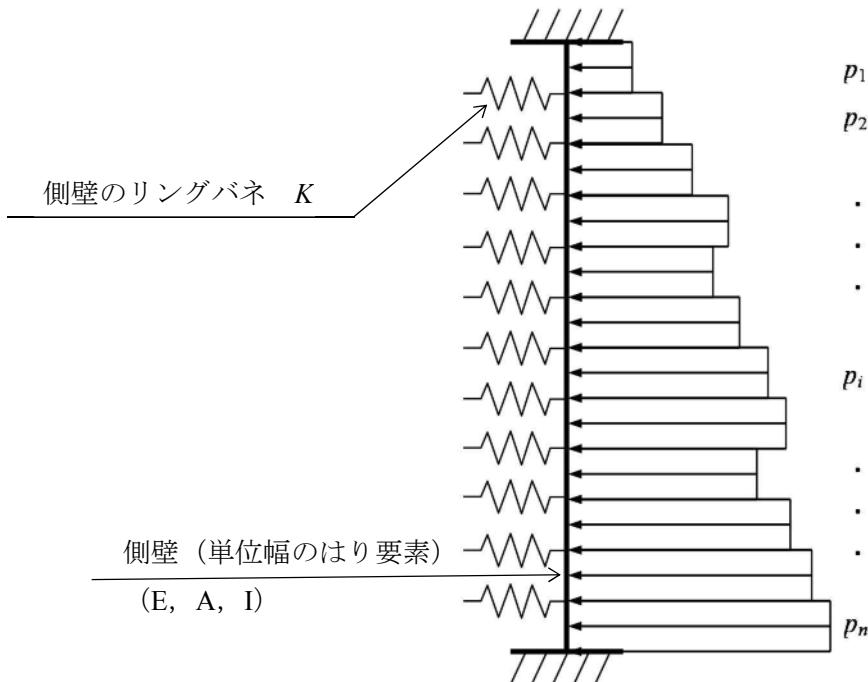
$p_i$  : 地盤応力 + 間隙水要素の応力
