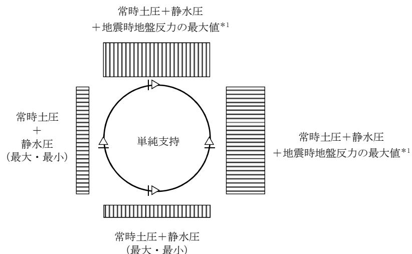
図 10-3 水平面設計における水平二方向の考慮
