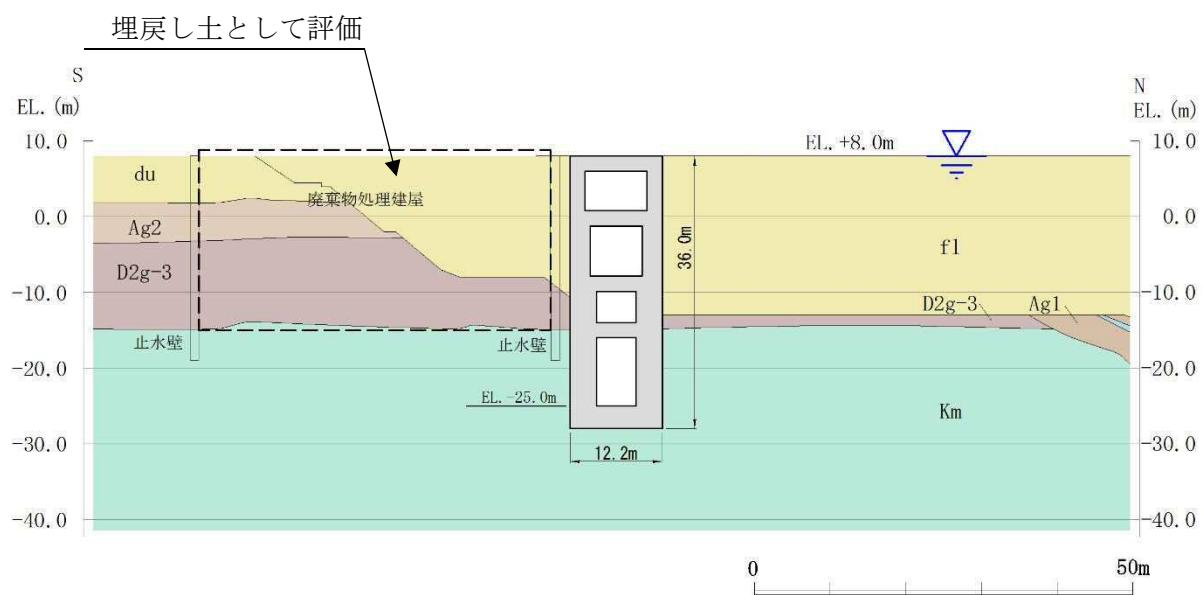
図 2-1 (3) 地質断面図（南北方向 B-B 断面）
