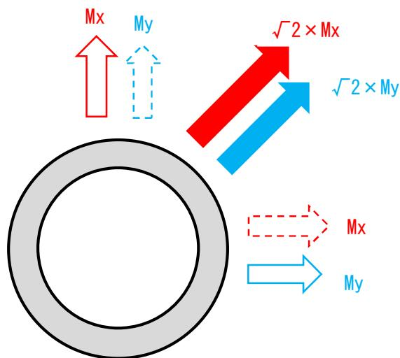
図 10-2 (1) 鉛直断面の曲げ軸力照査における水平二方向地震力の考慮
