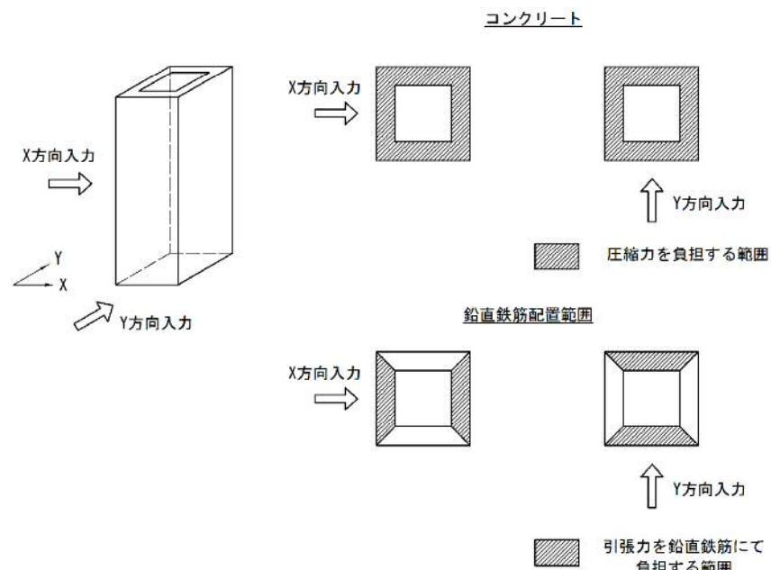
図 10-1 (1) 入力方向ごとの耐震要素（矩形立坑鉛直断面の曲げ・軸力を対象）
