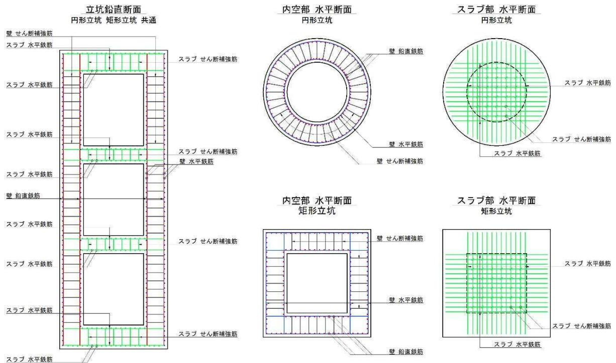
図 2-5 各部材評価で照査対象とする鉄筋
