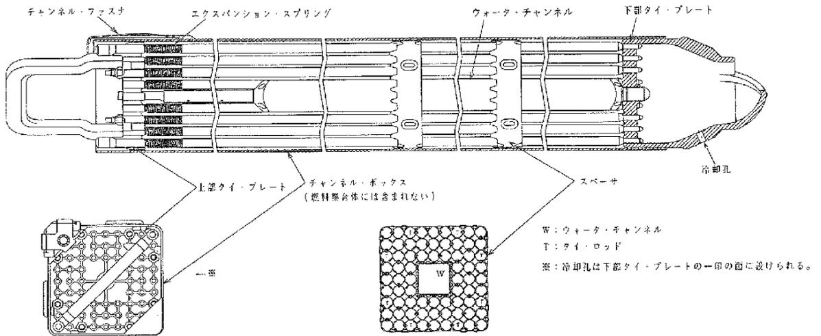
第 16-2 図 燃料集合体の概要 (9 × 9 燃料 (B 型))
