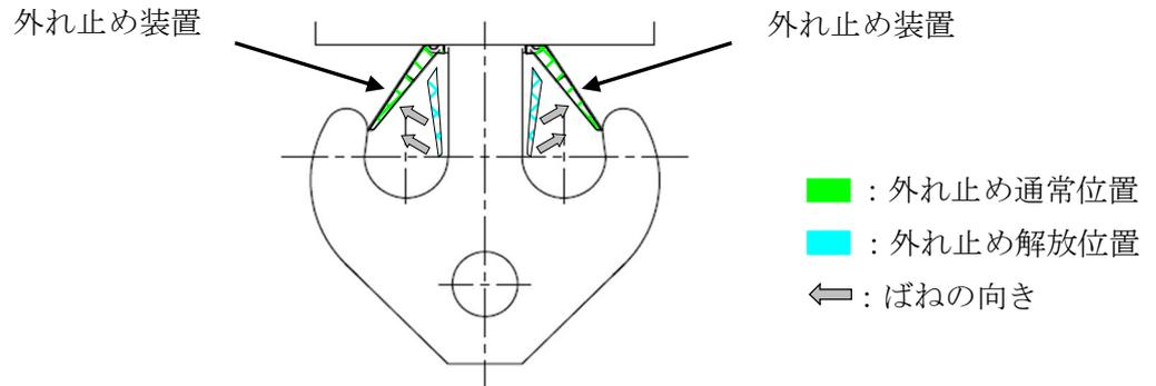
第5図 フックの外れ止め装置
