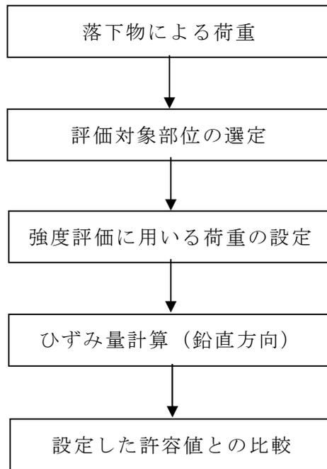
第 17 図 燃料集合体の強度評価フロー
