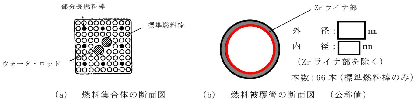
第 19 図 燃料集合体の断面図
