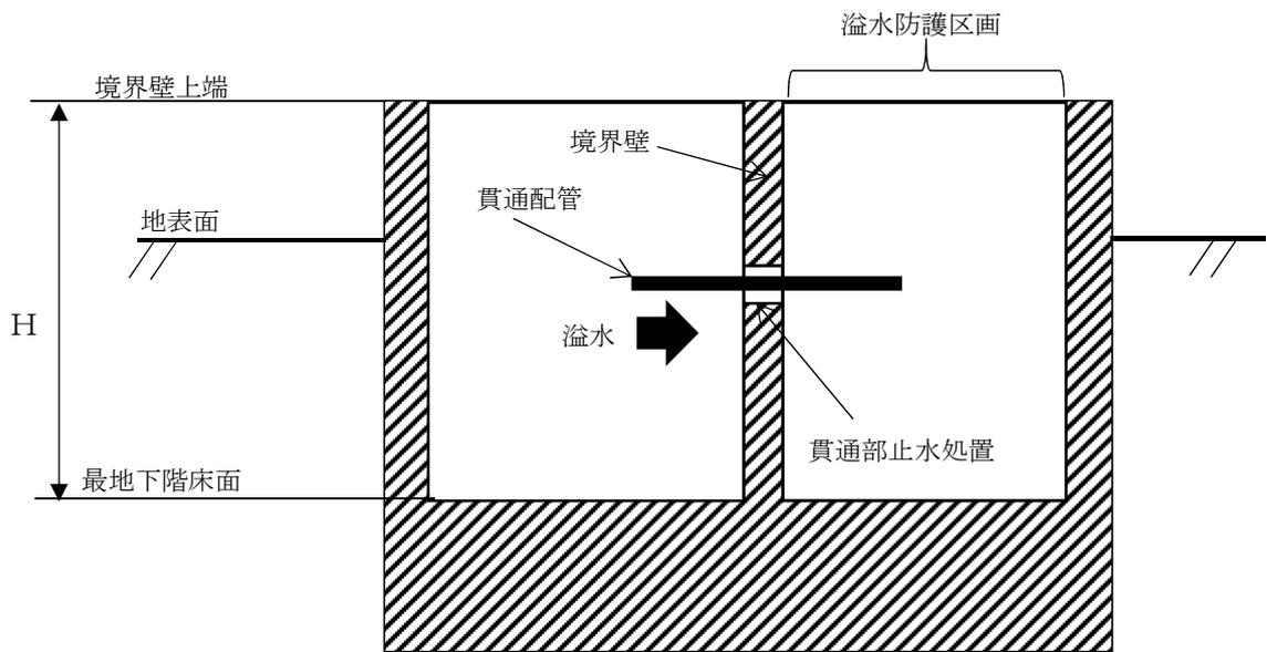
第 4-1 図 溢水による静水圧の算出に用いる浸水高さHの設定 (2/2)
