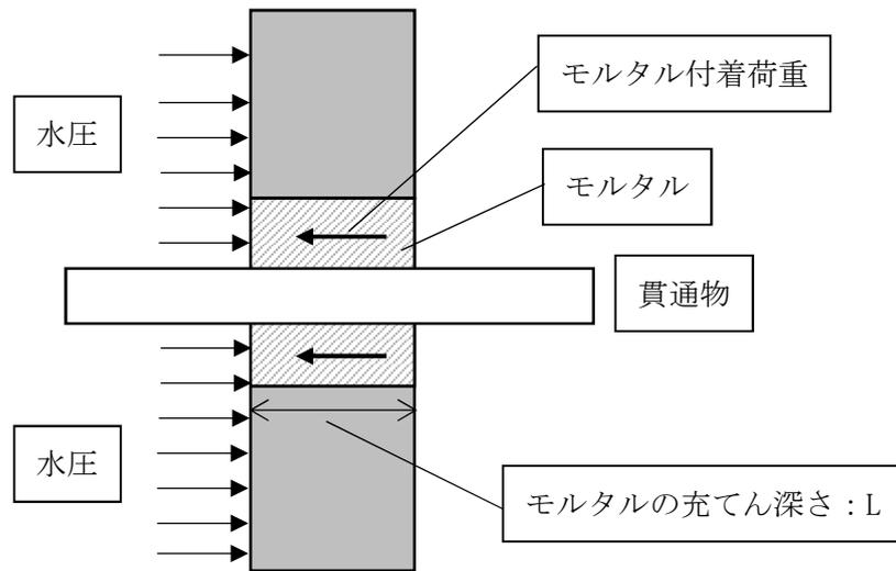
注：貫通物の自重は鉛直に作用し、水圧が作用する方向と異なるため考慮しない。
