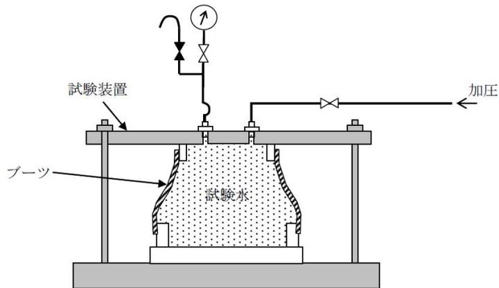
第3-2図 ブーツの水圧試験の概要
