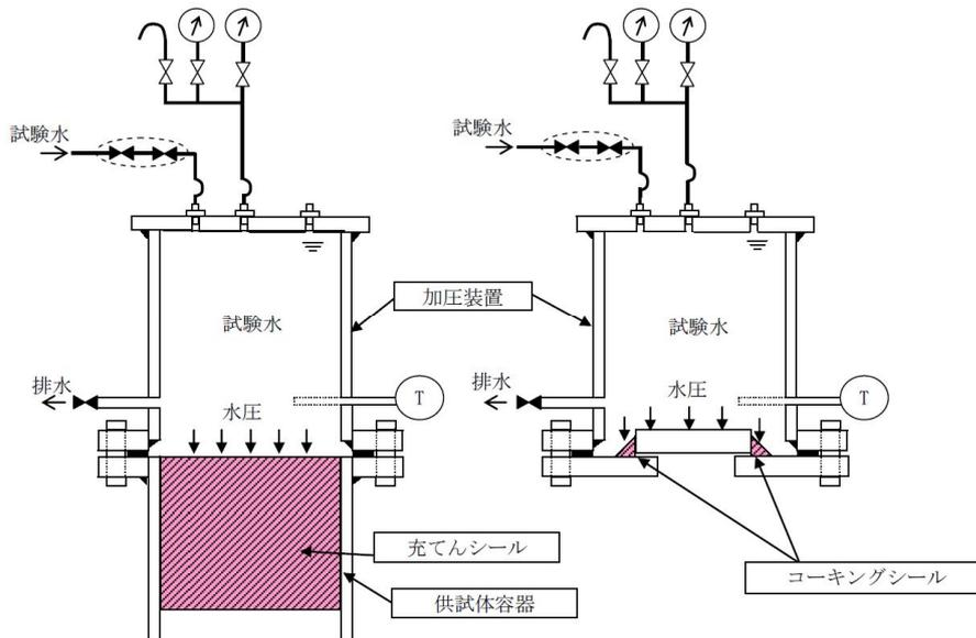
第3-1図 シール材の水圧試験の概要
