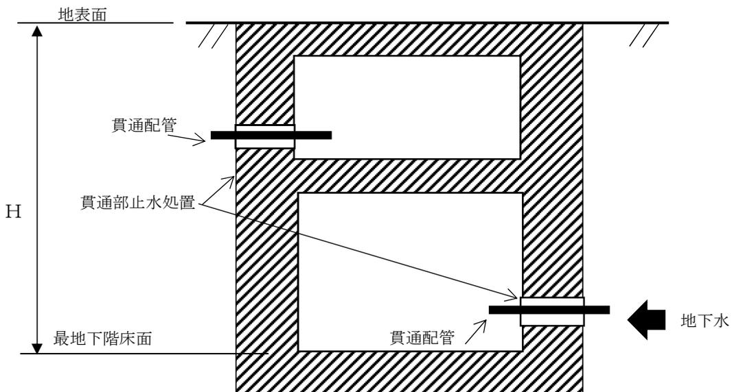
第4-1図 溢水による静水圧の算出に用いる浸水高さHの設定 (1/2)
