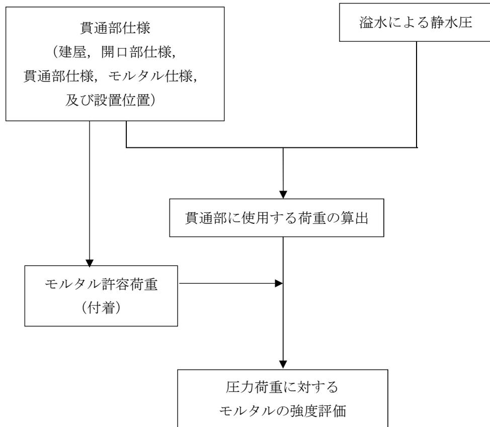
第 2-3 図 モルタルの強度評価フロー
