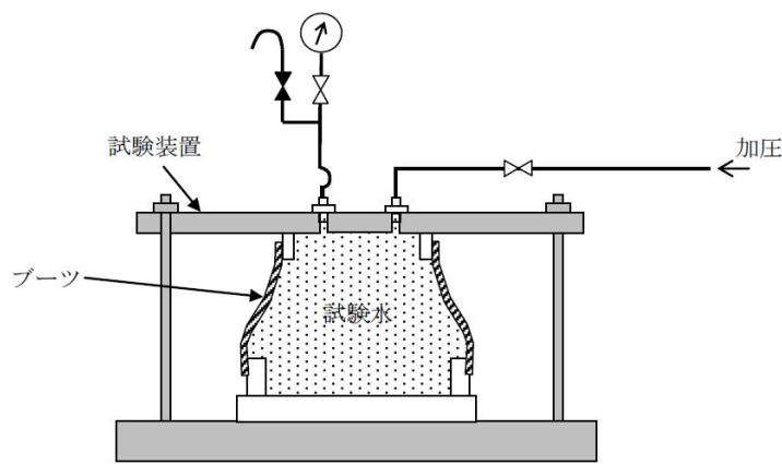
第3-2図 ブーツの水圧試験の概要
