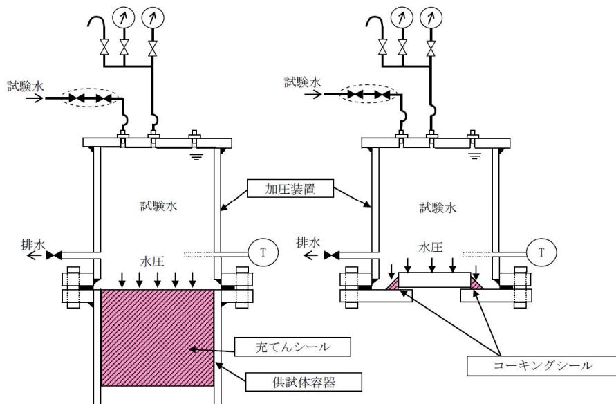
第3-1図 シール材の水圧試験の概要
