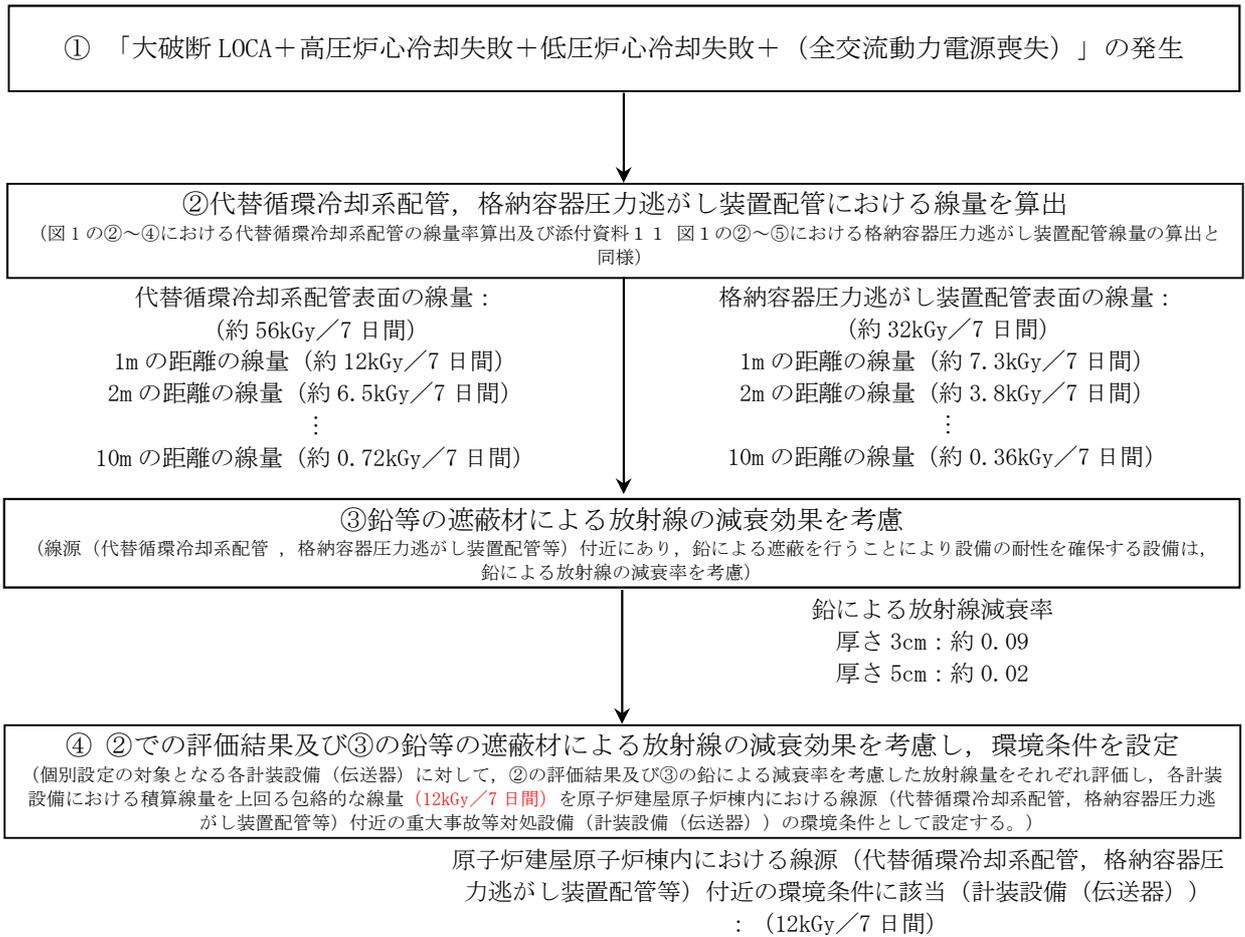
図2 重大事故時における原子炉建屋原子炉棟内の線源 (代替循環冷却系配管，格納容器圧力逃がし装置配管等) 付近の重大事故等対処設備 (計装設備 (伝送器)) に対する環境条件設定のフロー図
