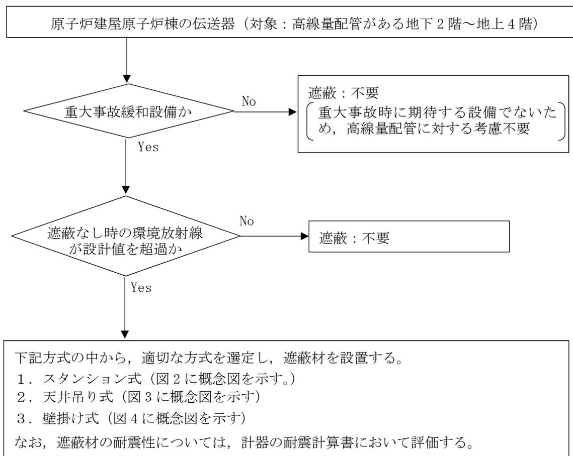
図1 遮蔽設置対象の伝送器選定フロー
