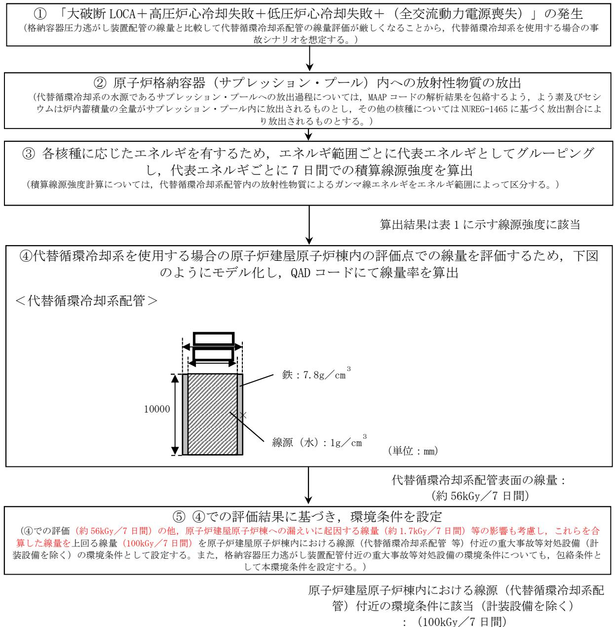
図1 重大事故時における原子炉建屋原子炉棟内の線源(代替循環冷却系配管等)付近の重大事故等対処設備(計装設備を除く)に対する環境条件設定のフロー図
