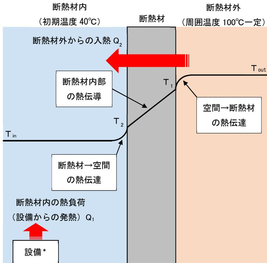
\* 非常用窒素供給系高圧窒素ポンベ及び非常用逃がし安全弁駆動系高圧窒素ポンベの評価においては窒素ポンベを、格納容器内水素濃度 (SA) 及び格納容器内酸素濃度 (SA) の評価においてはサンプリング装置を室温評価条件 (表1及び表2) における「断熱材内の熱負荷」として考慮。
