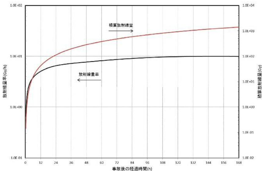
図 重大事故時における原子炉建屋原子炉棟内の放射線量率及び積算放射能量の経時変化
