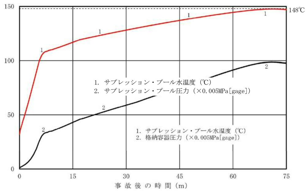
図2 サプレッション・プール水温度及び格納容器圧力の推移（長期）
