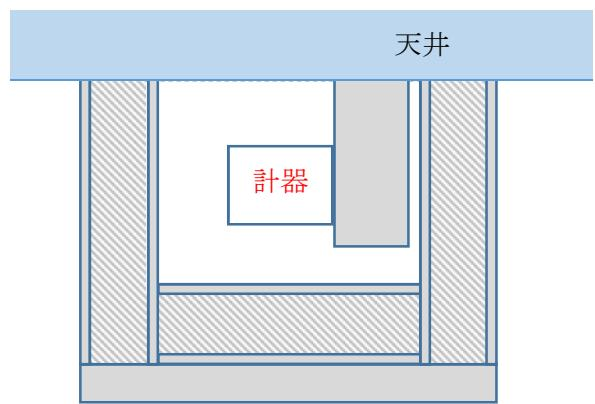
図3 天井吊り式概念図
