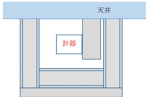
図3 天井吊り式概念図
