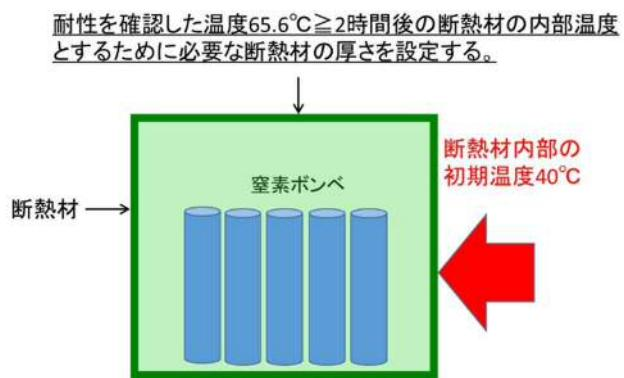
第1図 断熱材による対策概念図（窒素ボンベ）
