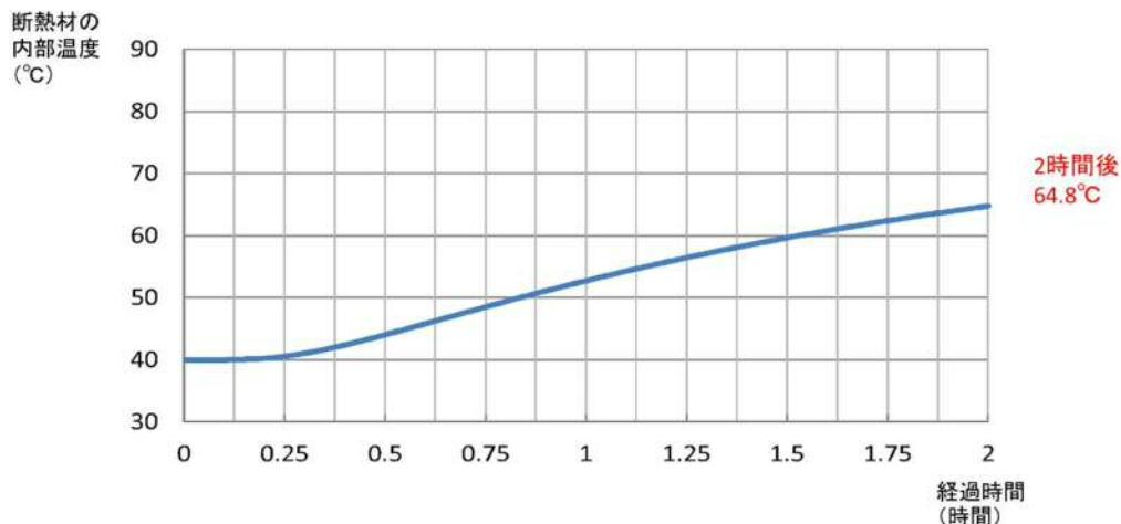
第2図 非常用窒素供給系高圧窒素ボンベ及び非常用逃がし安全弁駆動系高圧窒素ボンベの断熱材厚さの評価結果（断熱材外側：100°C・2時間、断熱材厚さ 50mmの場合）
