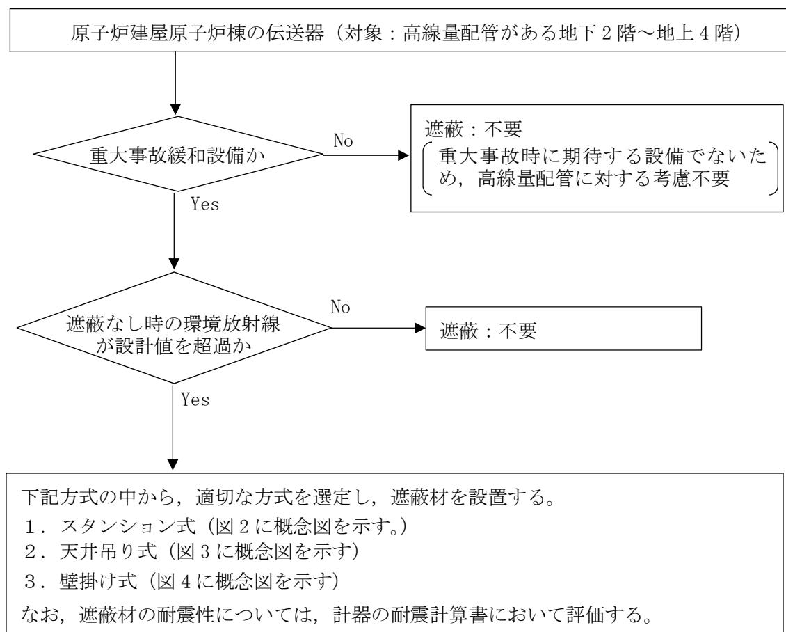
図 1 遮蔽設置対象の伝送器選定フロー
