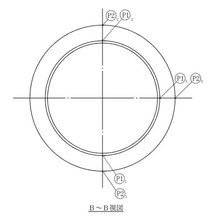
図 5-1 機器搬入用ハッチの応力評価点
