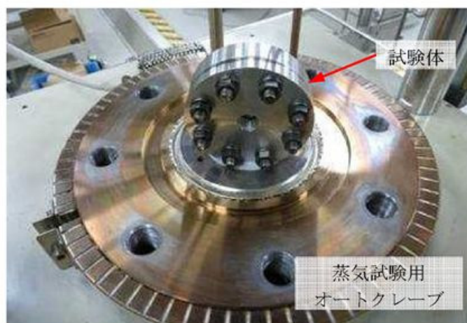
図4 蒸気曝露試験体設置状況
