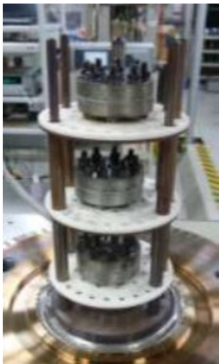
図4 蒸気曝露 試験片設置状況
