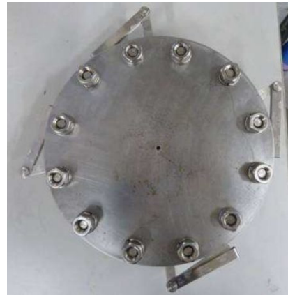
図8 変位付与状況 隙間ゲージを用いて所定の変位を加えた後、 隙間ゲージを抜いて再締め付け
