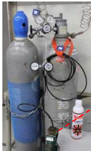
図5 気密確認試験状況
