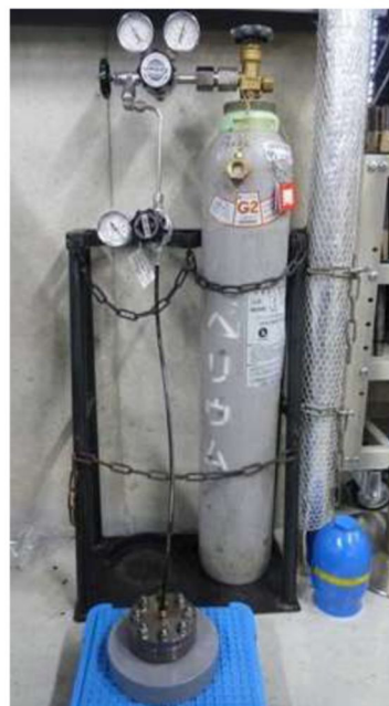
図 13 He 気密確認試験状況
