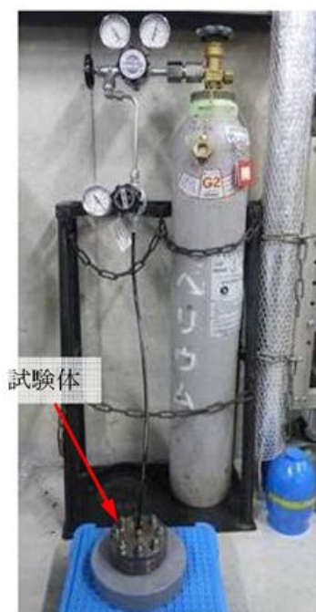
図5 He気密確認試験状況
