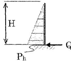
第3-2図 堰に生じる応力の概念図
