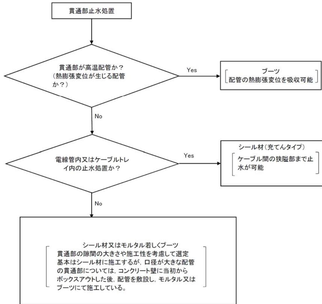
第3-3図 貫通部止水処置の選定フロー
