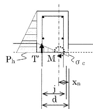
第 5-13 図 壁に生じる圧縮力の概念図
