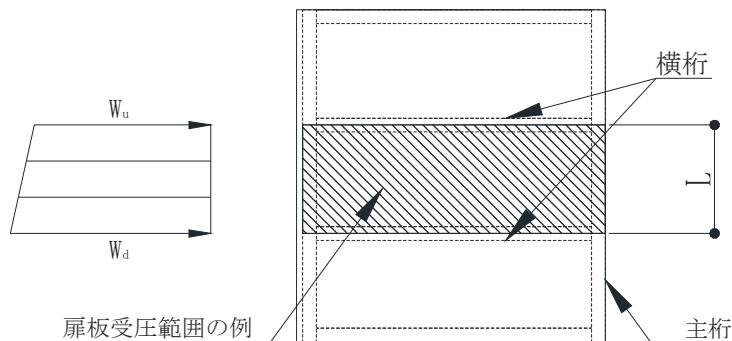
第5-2図 応力算定モデル図 (扉板材)
