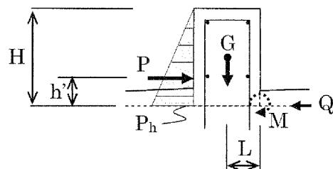
第5-15図 堤の応力算定モデル
