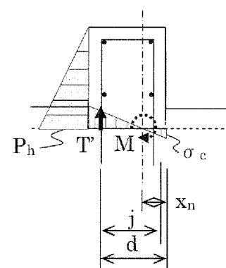
第5-19図 堤に生じる圧縮力の概念図
