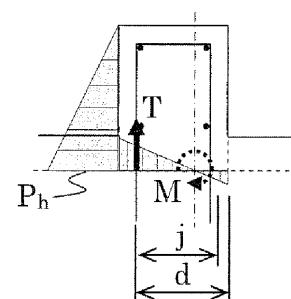
第 5-12 図 壁に生じる引張力の概念図
