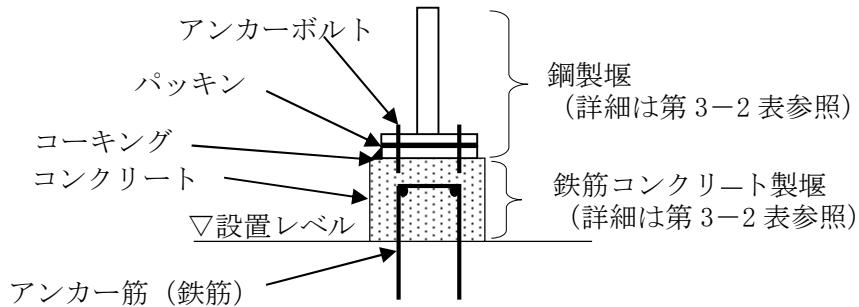
第3-2図 鉄筋コンクリート製堰及び鋼製堰にて構成される堰の説明図
