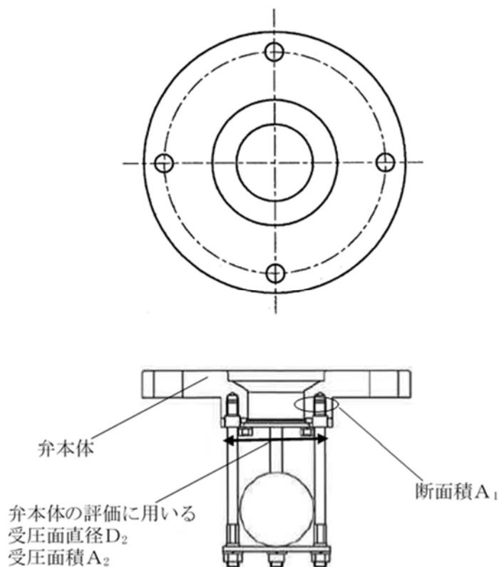
第5-20図 弁本体の強度評価に用いる受圧面直径及び断面積
