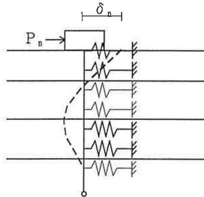
(4) 水平荷重試験における杭頭変位との比較
