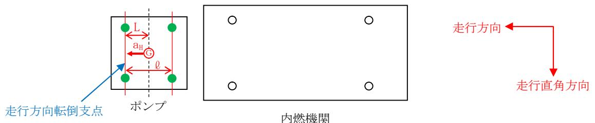
図 3-5-1 可搬型代替注水大型ポンプの評価部位概略図（直接支持構造物）(1/2)
