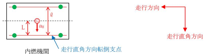
図 3-5-2 可搬型代替注水中型ポンプの評価部位概略図（直接支持構造物）(1/2)
