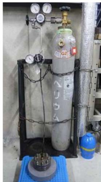
図 13 H e 気密確認試験状況
