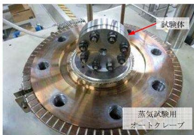
図4 蒸気曝露試験体設置状況
