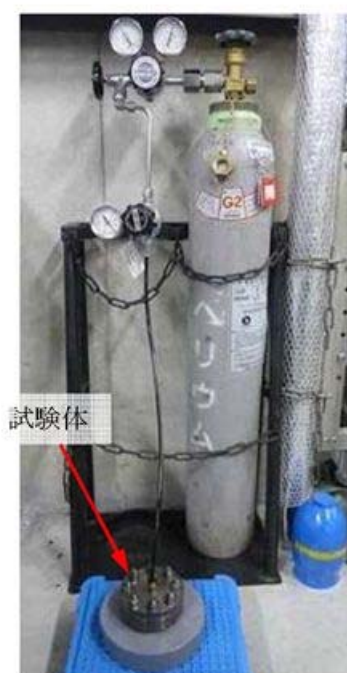
図5 H e 気密確認試験状況
