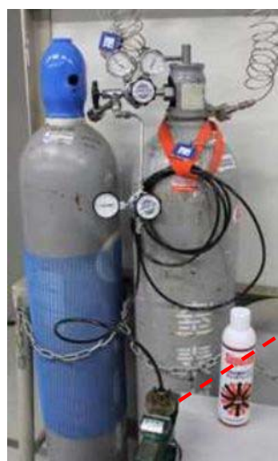
図5 気密確認試験状況
