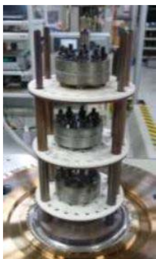
図4 蒸気曝露 試験片設置状況
