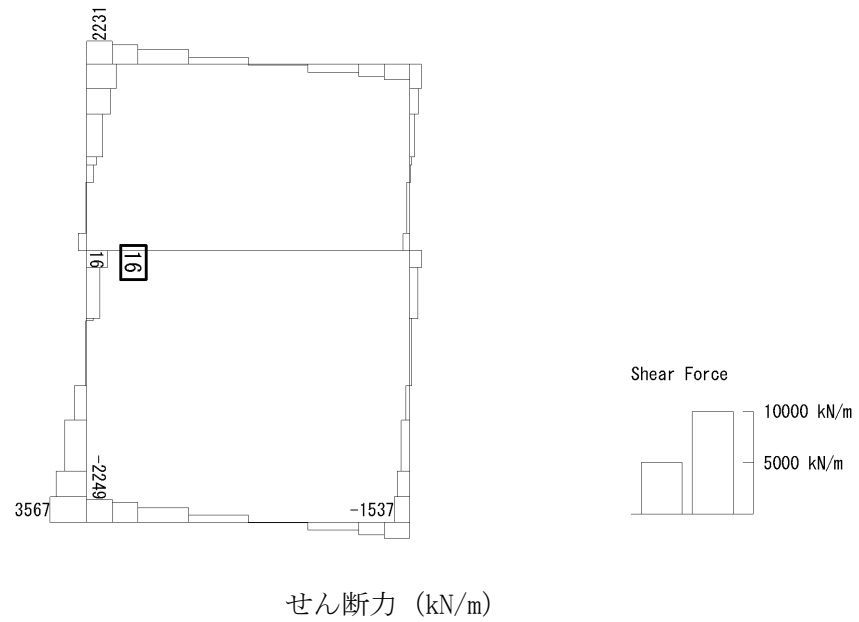
図 6.4-20 (12) ピット部中壁コンクリートの曲げ軸力照査に用いる断面力図 ( S_s-D1 (H-, V-), t=23.33s ) (検討ケース①: 原地盤に基づく液状化強度特性を用いた解析ケース)
