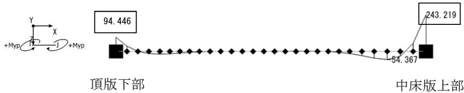
図 14.4-11(4) 側壁両端固定梁モデルにおける曲げモーメント図
