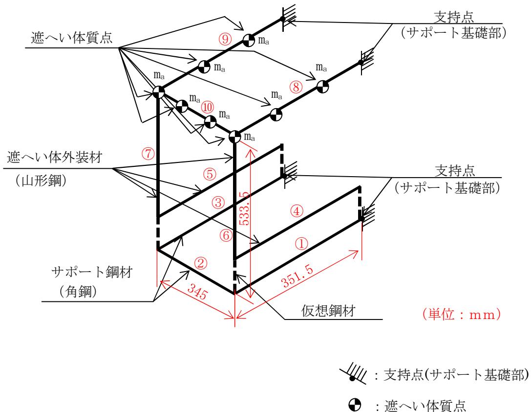
図 2-2 低圧代替注水系格納容器下部
