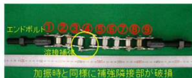
加振時と同様に補強隣接部が破損 部分溶接タイプ
