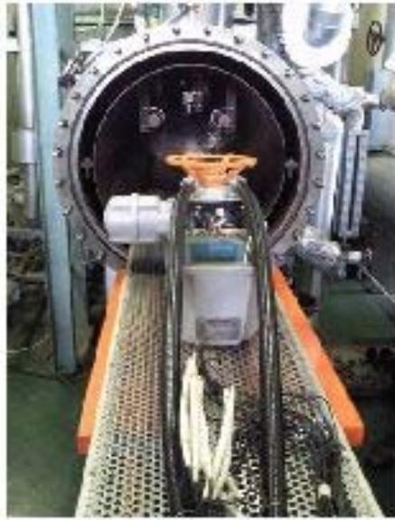
图 5.11-2 蒸气暴露试验装置 (例)
