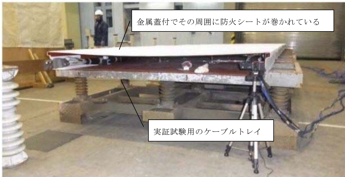
第3図 実証試験用のケーブルトレイ
