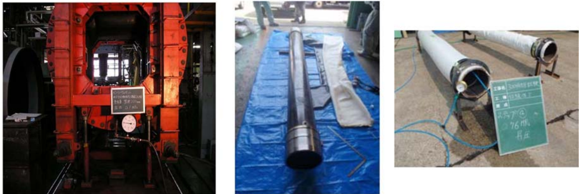
第 1-26 図 止水ゴム等の耐圧試験例
