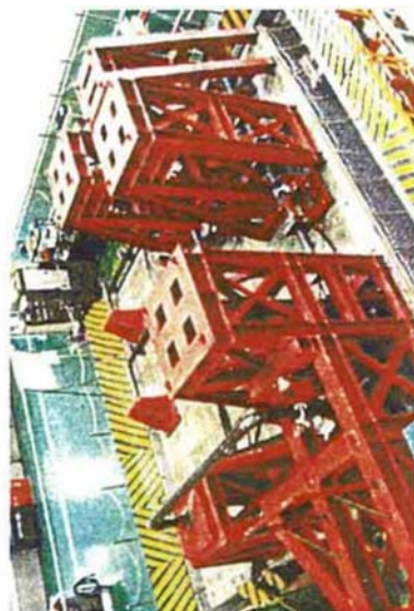
実規模配管系試験装置
