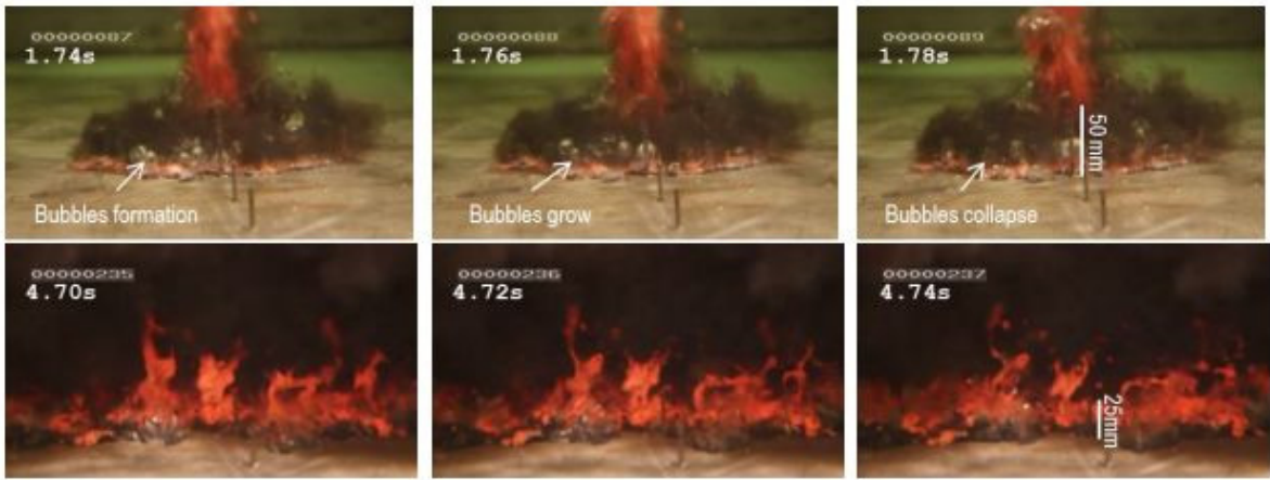
付図 4-8 PULiMS 実験 E4 ケースの溶融物拡がり挙動のスナップ写真 [21]
