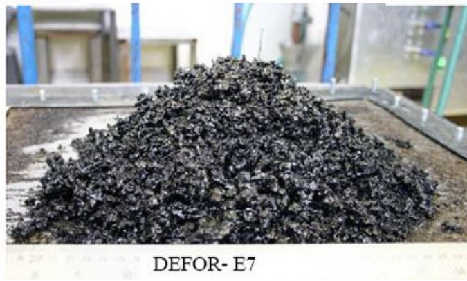
付図 3-6 DEFOR-E 実験後のデブリ状態 [16]
