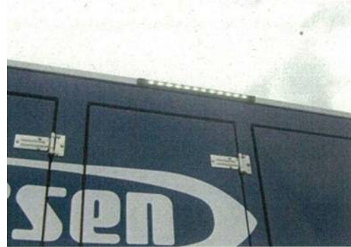
車両の作業用照明
