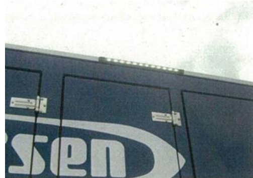
車両の作業用照明
