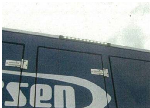
車両の作業用照明
