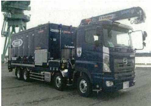
可搬型代替注水大型ポンプ
