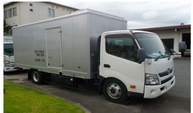
可搬型代替低圧電源車
