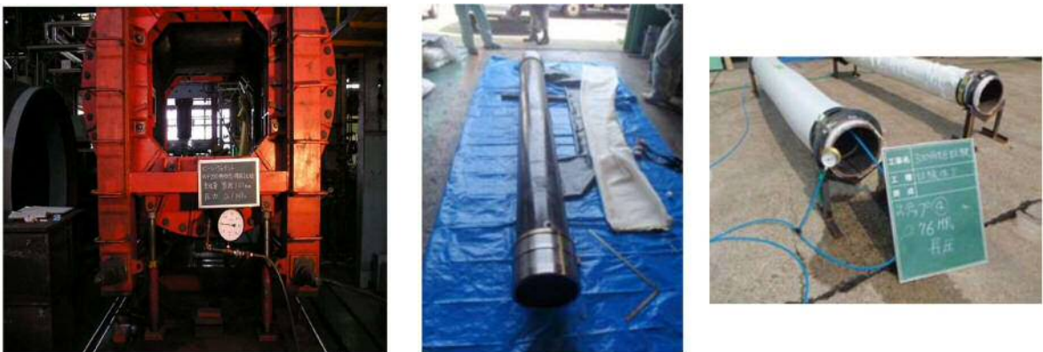
第 13 図 止水ゴム等の耐圧試験例
