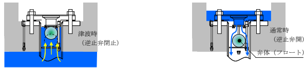
緊急用海水ポンプ室床 dren 排出口逆止弁の津波時の動作概要
