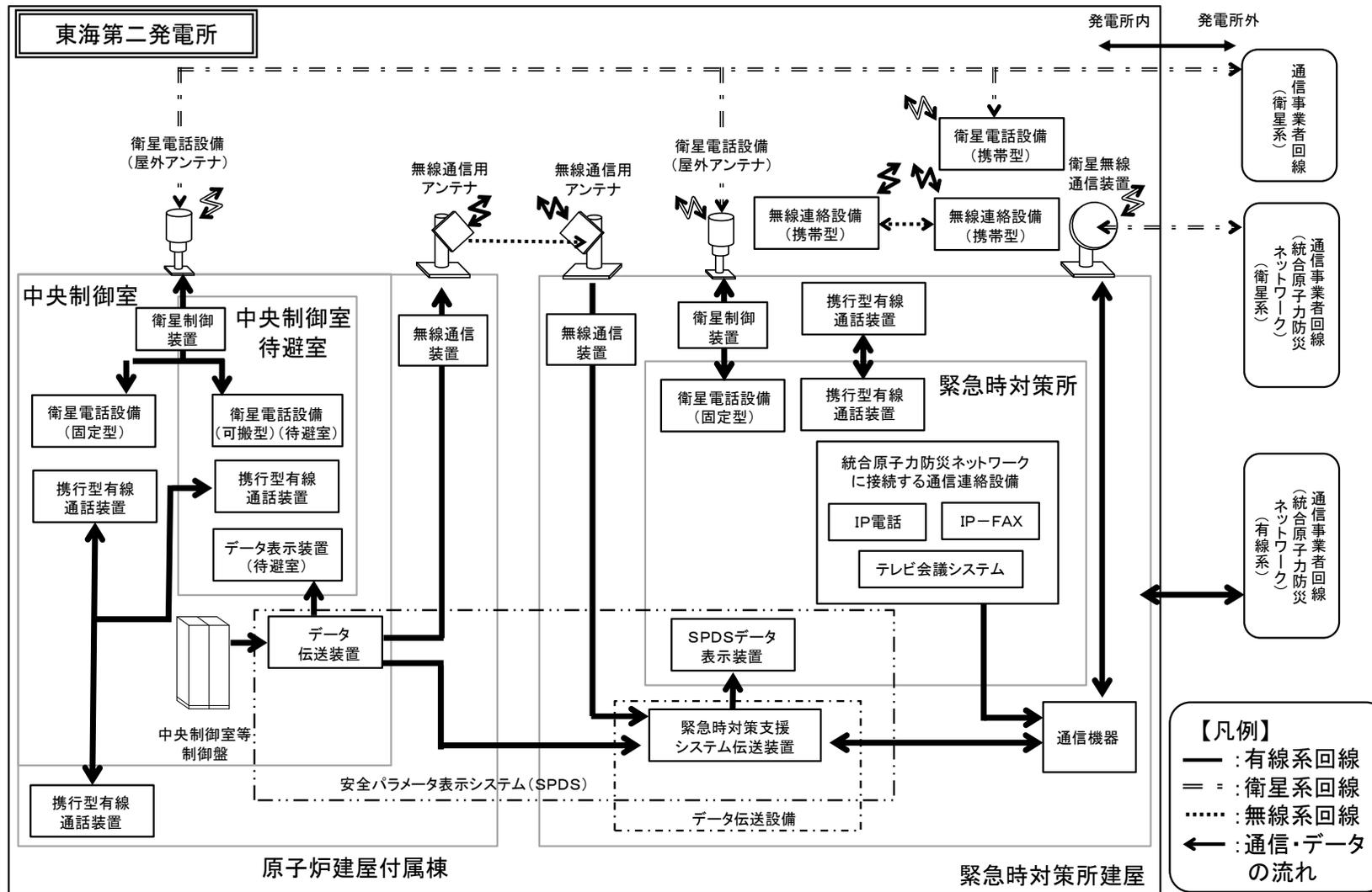
第 1.19-1 図 通信連絡設備の系統概要図
