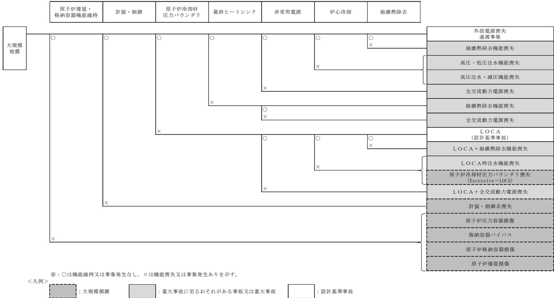
第 2.1.2 図 大規模な自然災害（地震）により生じ得る発電用原子炉施設の状況（1/3）
