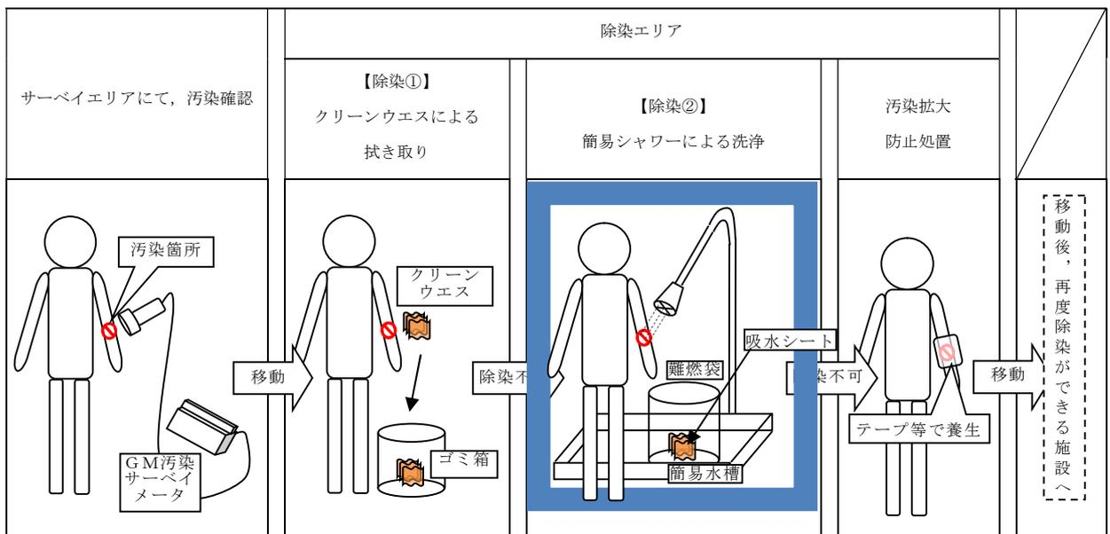
第4図 除染及び汚染水処理イメージ図
