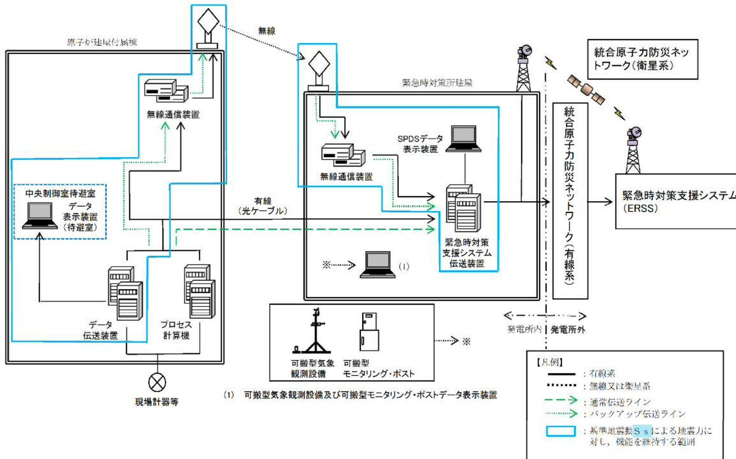
図1.1 データ伝送設備（発電所内）及びデータ伝送設備（発電所外）に関わる耐震措置の概要
