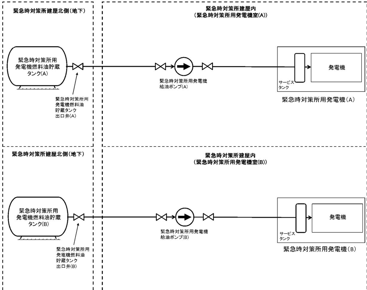
第1.18.2.4-2図 緊急時対策所燃料系統概略図
