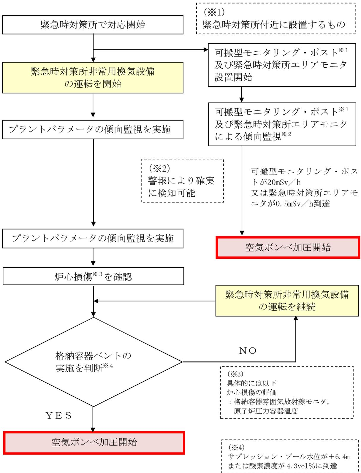
第 1.18.2.1-7 図 緊急時対策所加圧設備による加圧判断のフローチャート
