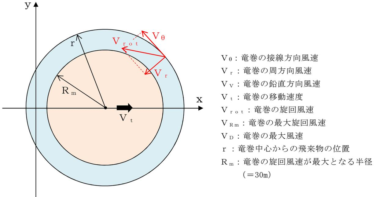
$$\frac{C_D A}{m} (\text{空力パラメータ}) > \frac{2g}{\rho V_v \sqrt{V_D^2 + V_v^2}} \quad \text{が成立すれば, 物体は浮き上がるこ}$$
