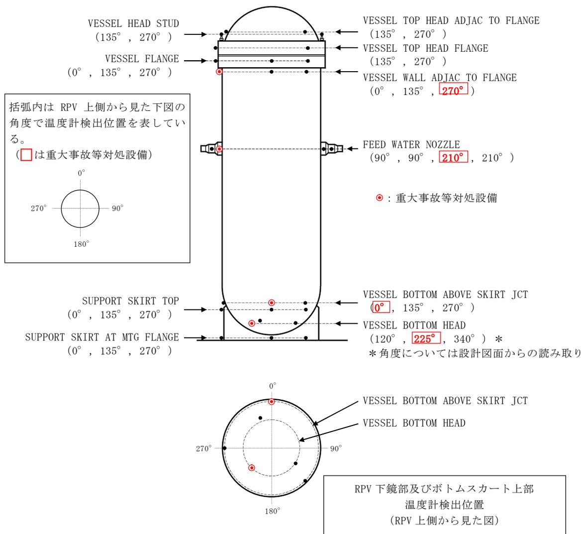
第 58 条で重大事故等対処設備とする温度計の検出位置は代表性を考慮して RPV 上部，中部，下鏡部及びボトムスカート上部各々 1 箇所としている。
