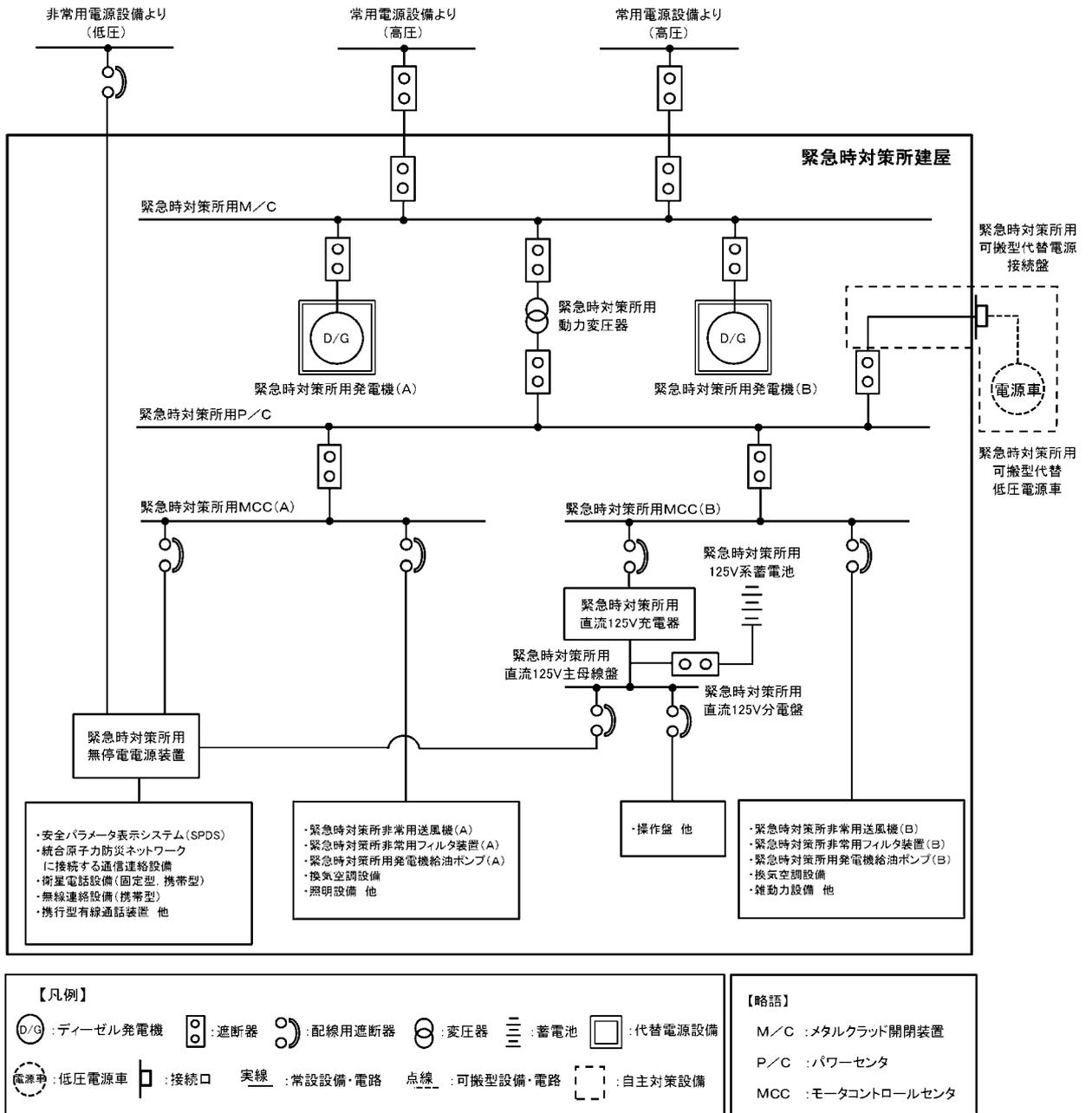
第1.18.2.4-1図 緊急時対策所電源系統概略図
