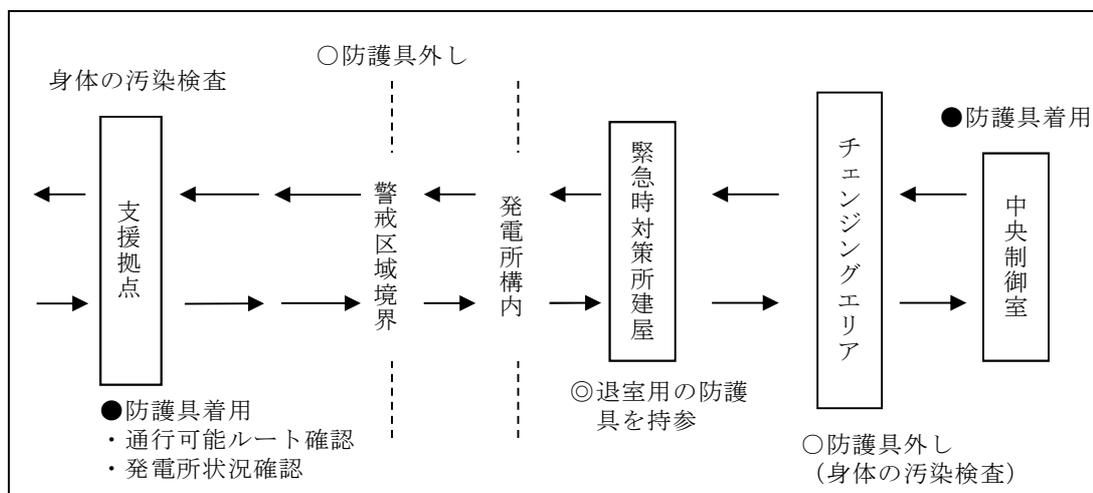
第1図 放射線防護措置と移動経路
