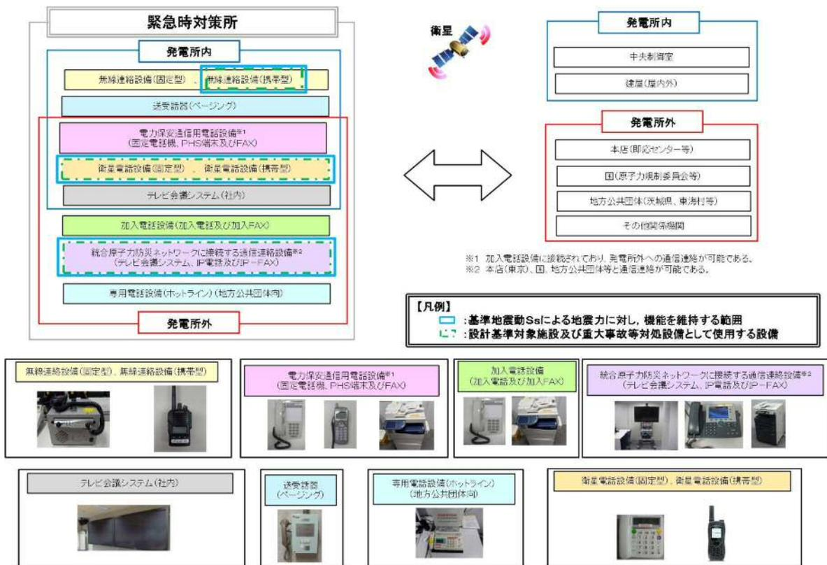
図10 緊急時対策所の通信設備（発電所内）及び通信設備（発電所外）
