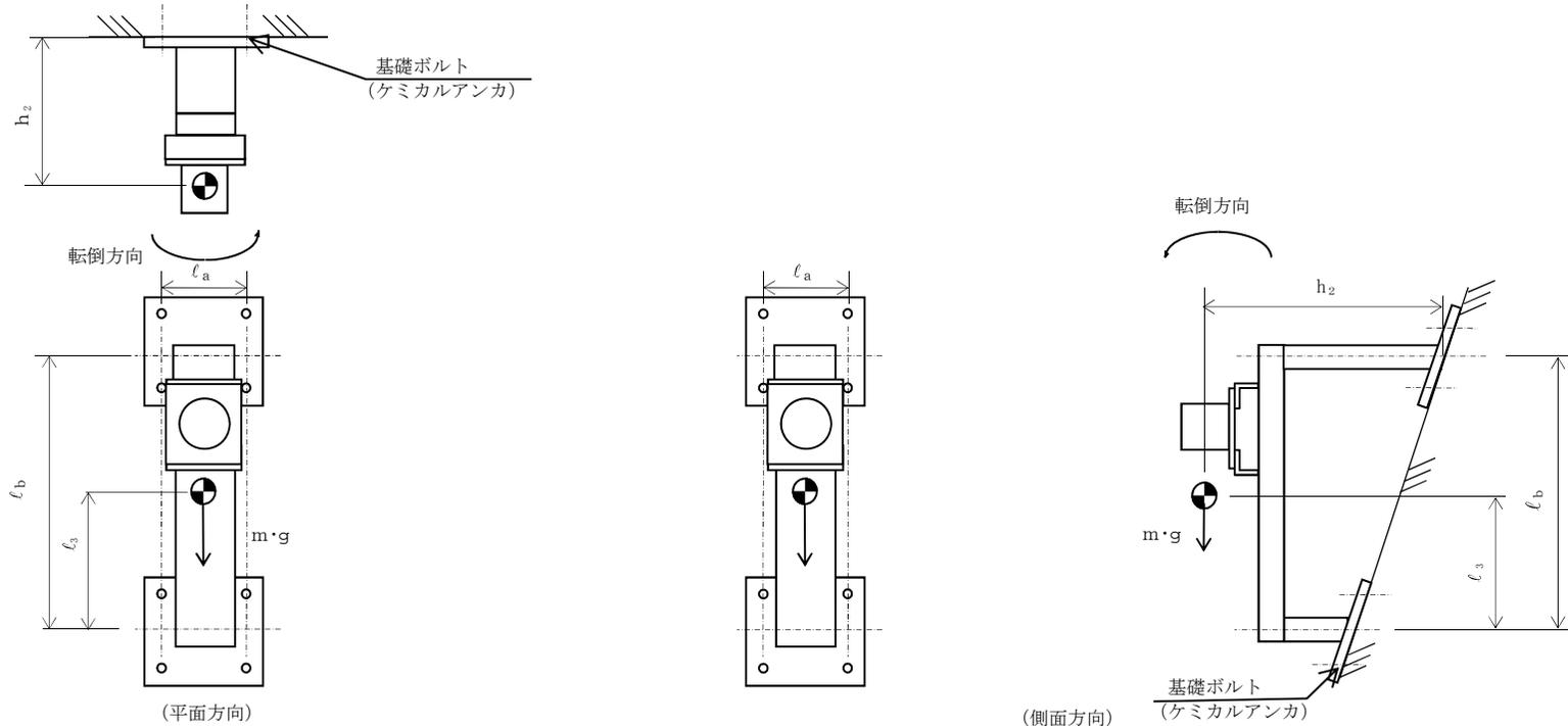
【原子炉圧力計（S A）の耐震性についての評価結果】
