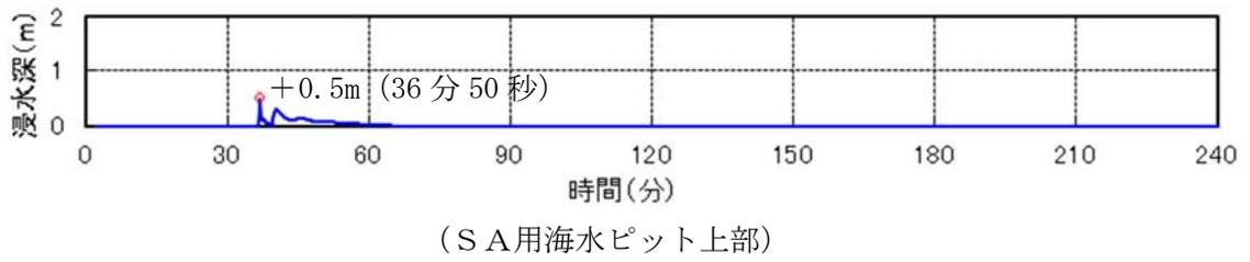
図 1.5-21 敷地内評価点における浸水深を示す時刻歴波形 (2/2)
