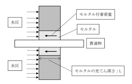
注: 貫通物の自重は鉛直に作用し、水圧が作用する方向と異なるため考慮しない。 第3-3図 モルタルの施工例
