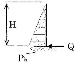
第3-2図 堤に生じる応力の概念図
