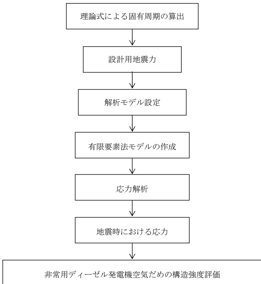
図 2-1 非常用ディーゼル発電機空気だめの耐震評価フロー
