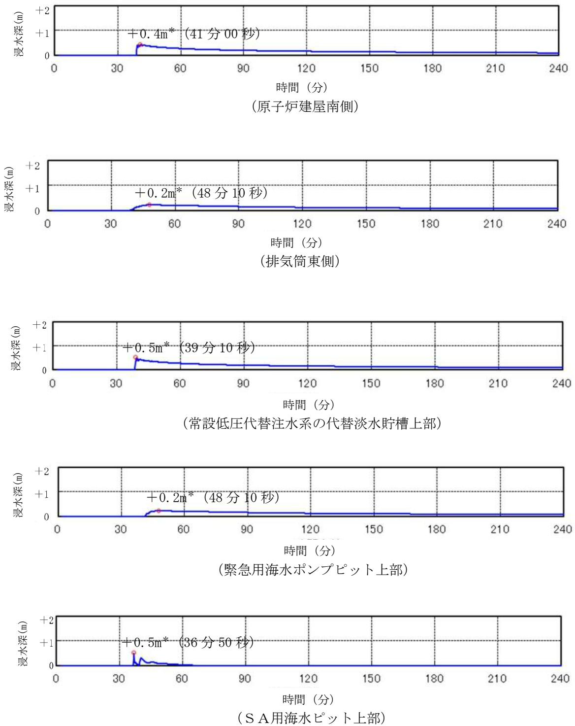
図 4-4 防潮堤内側における浸水深を示す時刻歴波形
