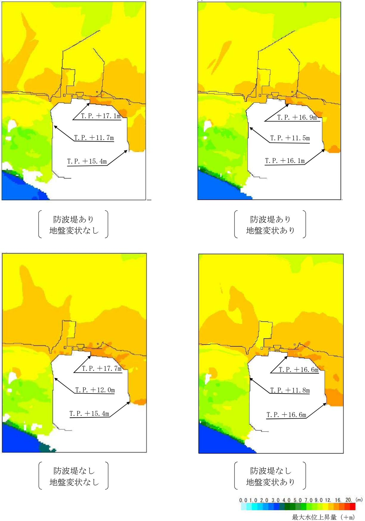
図 3-3 基準津波による遡上解析結果（最大水位上昇量分布）
