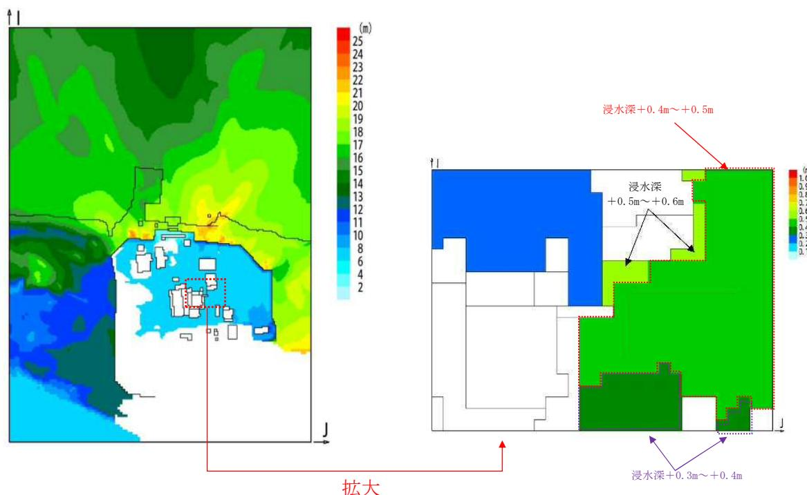
図 4-3 防潮堤内側の入力津波設定における浸水深の東海発電所の人工構造物の影響確認
