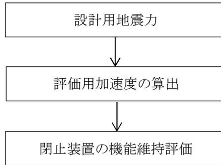
図 2-2 閉止装置の機能維持評価フロー
