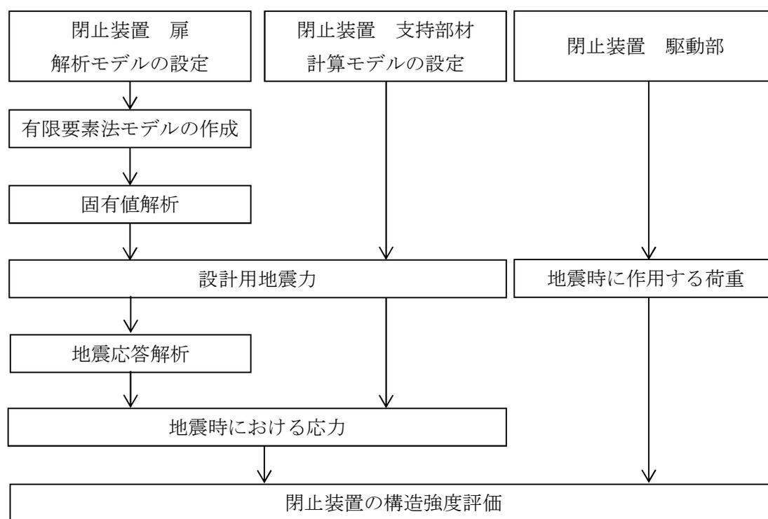
図 2-1 閉止装置の耐震評価フロー
