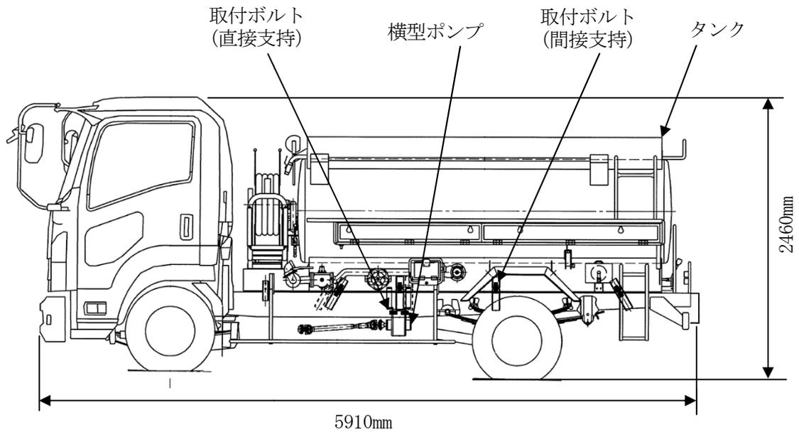
図2-6 タンクローリの構造図 (外観図)
