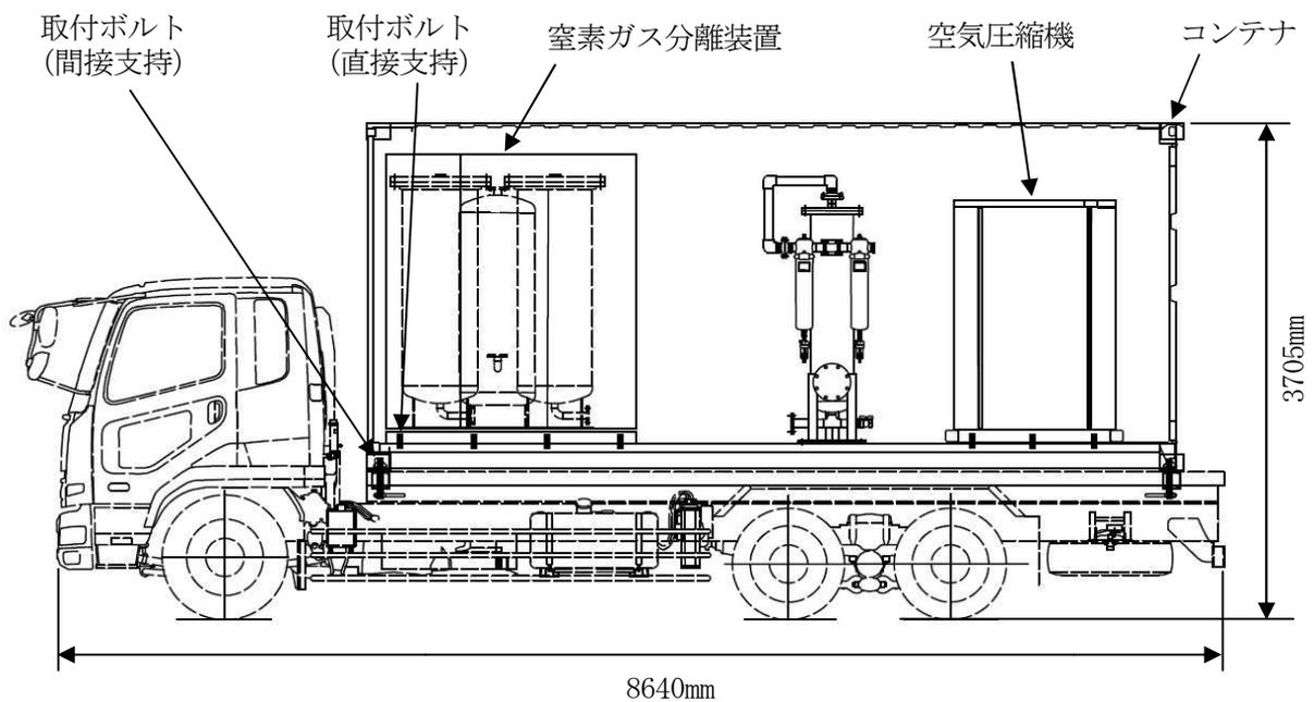
図2-5 窒素供給装置の構造図 (外観図)
