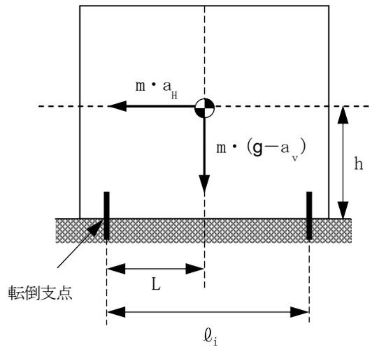
図4-2 間接支持構造物の計算モデル例
