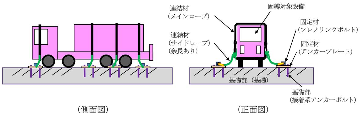
図 2-7 固縛装置の構造概要
