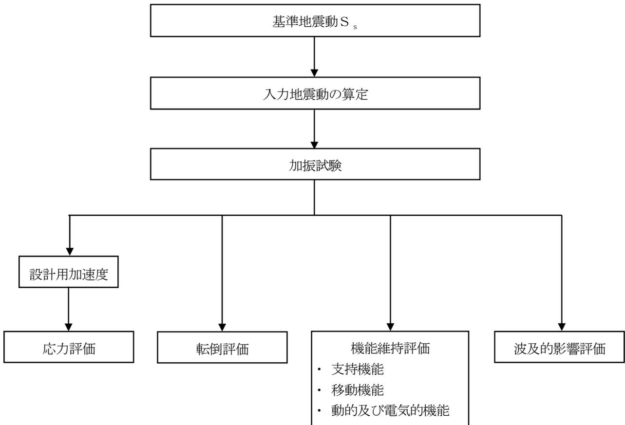
図2-8 車両型設備の耐震評価フロー
