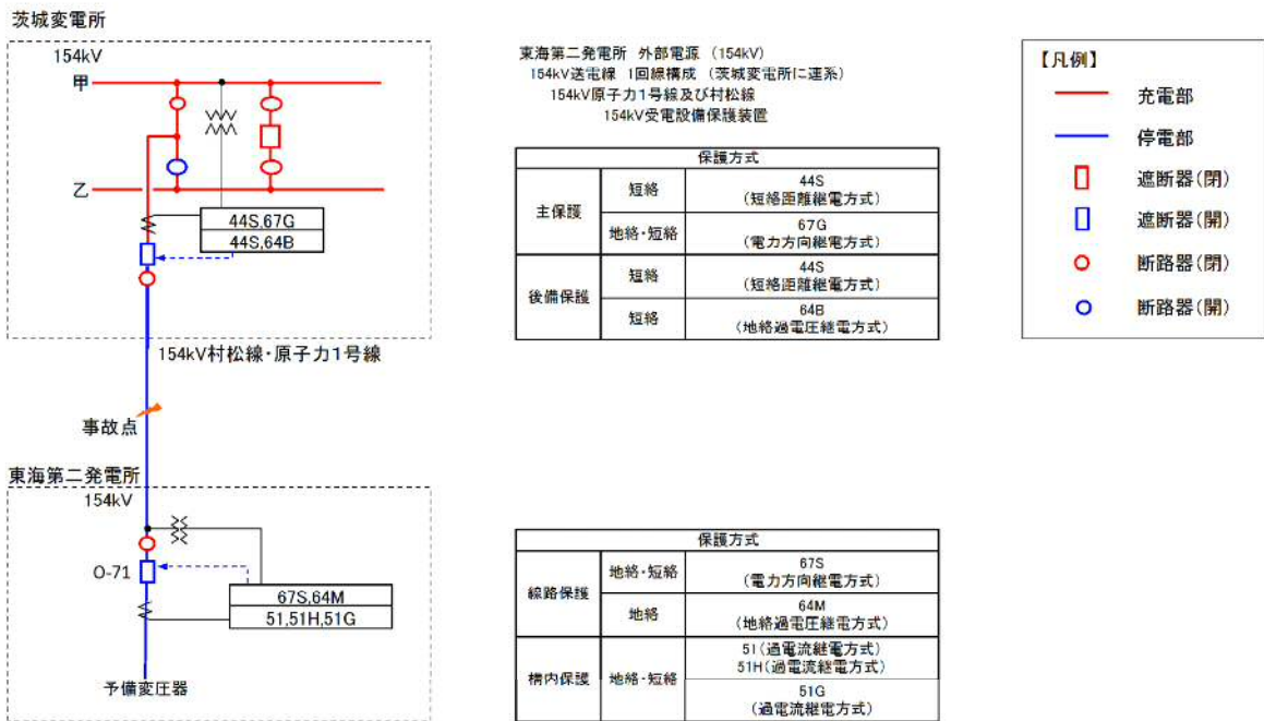
図 1-3 送電線保護装置 (154kV 村松線・原子力1号線1回線)
