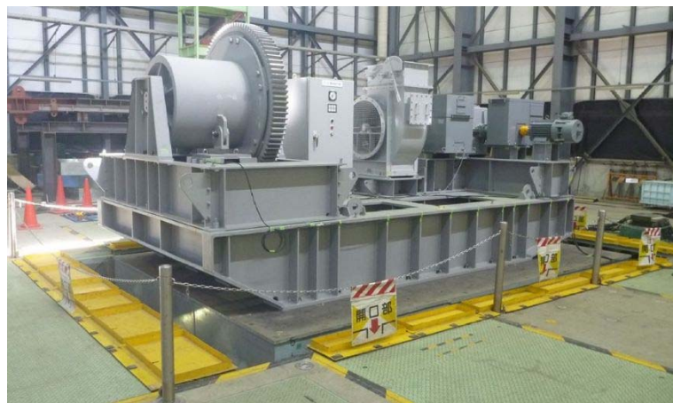
第9図 開閉装置の試験装置（全景）
