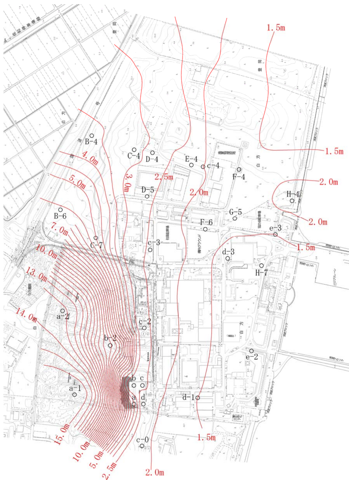
第 1 図 観測最高地下水位コンター図
