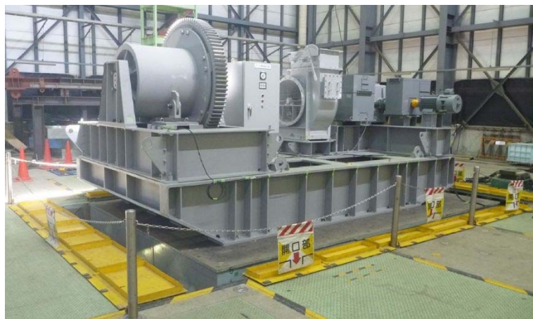
第9図 開閉装置の試験装置（全景）
