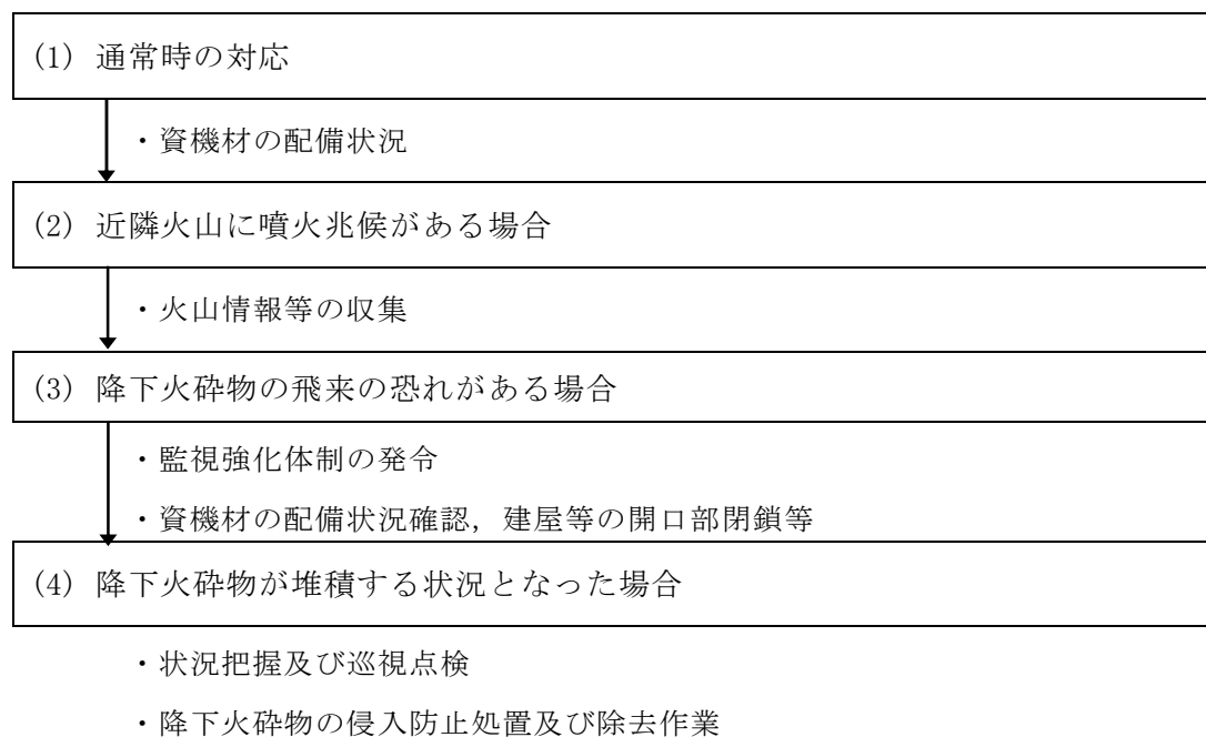
第 3.7.1-1 図 降下火砕物に対応するための運用管理フロー
