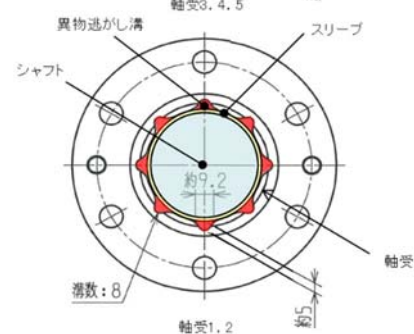
第 5 図 非常用ディーゼル発電機（高圧炉心スプレイ系ディーゼル発電機を含む。）用海水ポンプ軸受部
