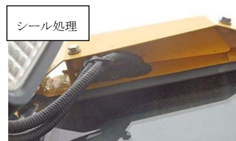
第 1 図 可搬型設備 小動物対策例 (2/2)
