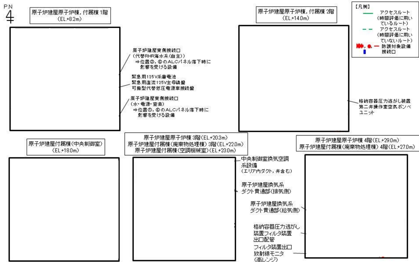
第2図 原子炉建屋付属棟の ALC パネルの損傷・脱落により, 影響を受ける可能性のあるアクセスルート
