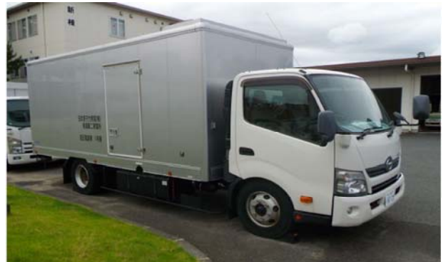
可搬型代替低圧電源車
