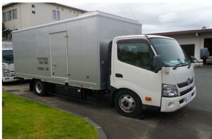
可搬型代替低圧電源車
