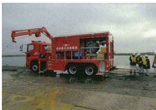
可搬型代替注水中型ポンプ
