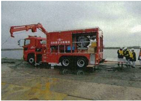
可搬型代替注水中型ポンプ
