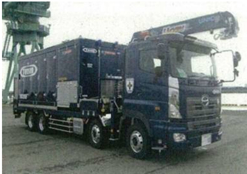
可搬型代替注水大型ポンプ
