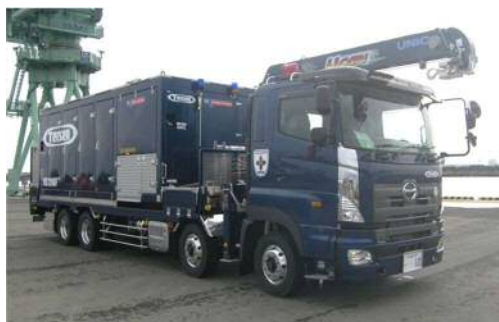
可搬型代替注水大型ポンプ
