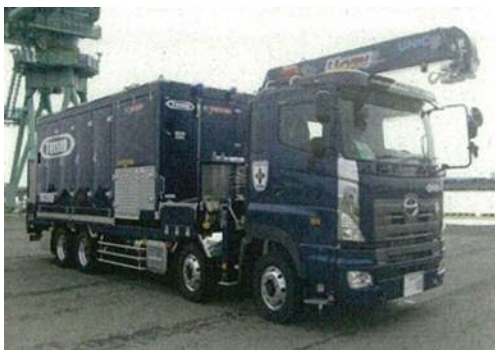
可搬型代替注水大型ポンプ
