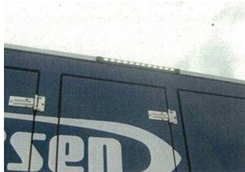
車両の作業用照明
