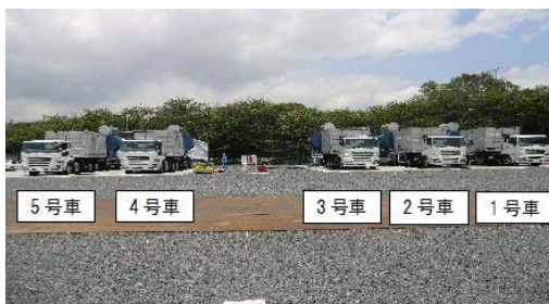
常設代替高圧電源装置（イメージ）
