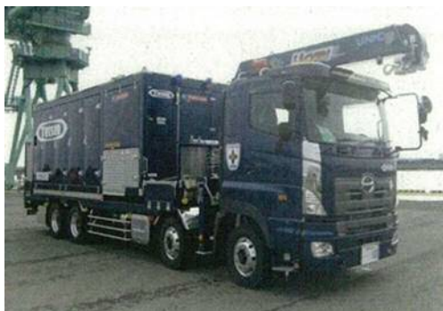
可搬型代替注水大型ポンプ
