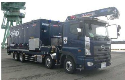
可搬型代替注水大型ポンプ（放水用）
