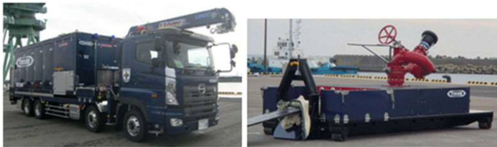
第4図 可搬型代替注水大型ポンプ（放水用）、放水砲
