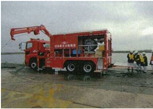
可搬型代替注水中型ポンプ
