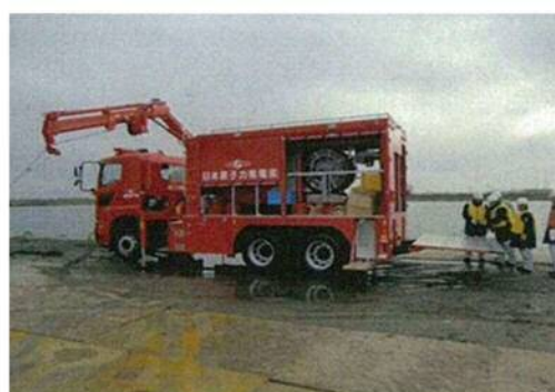
可搬型代替注水中型ポンプ
