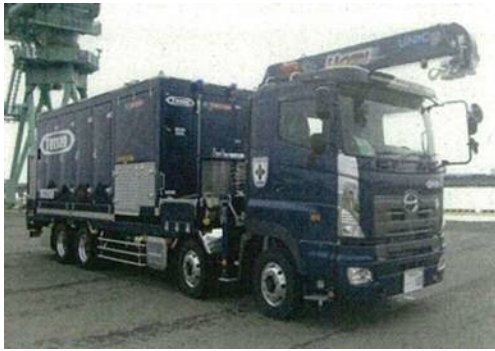
可搬型代替注水大型ポンプ
