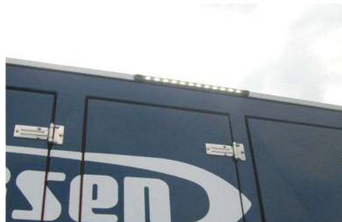
車両の作業用照明
