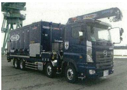
可搬型代替注水大型ポンプ
